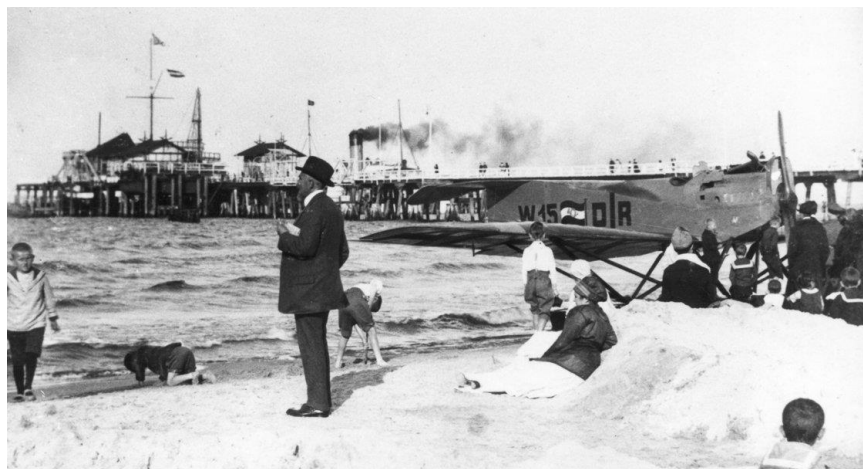
Wasserflugzeug vom Typ Friedrichshafen FF 49 mit der Zulassung DLR W5. Maschinen dieses Typs standen an der Ostseeküste den ganzen Sommer hindurch im Rundflugeinsatz. Die militärischen Kennzeichen waren gelöscht bis auf die Balkenkreuze auf der Flügeloberseite. Auf der Unterseite des unteren Tragdecks trugen die meisten FF 49 den Schriftzug „DLR“ in großen Lettern.
