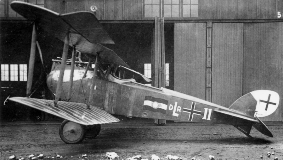
Die LVG C VI, WNr. 4830, Zulassung DLR 11, als offenes Passagierflugzeug bei der Deutschen Luft-Reederei.
