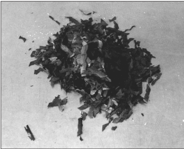
Bild 4: Reifenprobe – Späne von der Lauffläche
