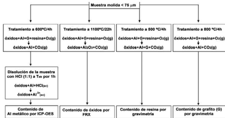
Figura 6. Esquema del método de análisis utilizado.
