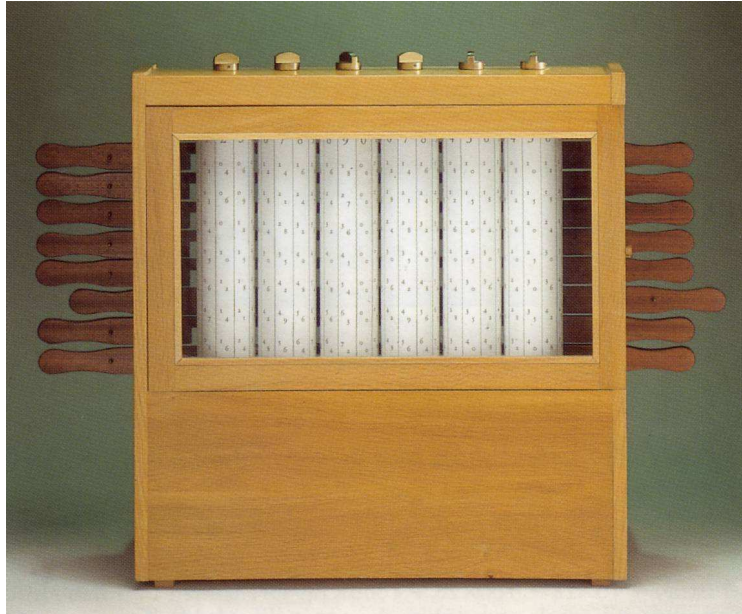
Abb. 7.11 Rückansicht mit den sechs Walzen
