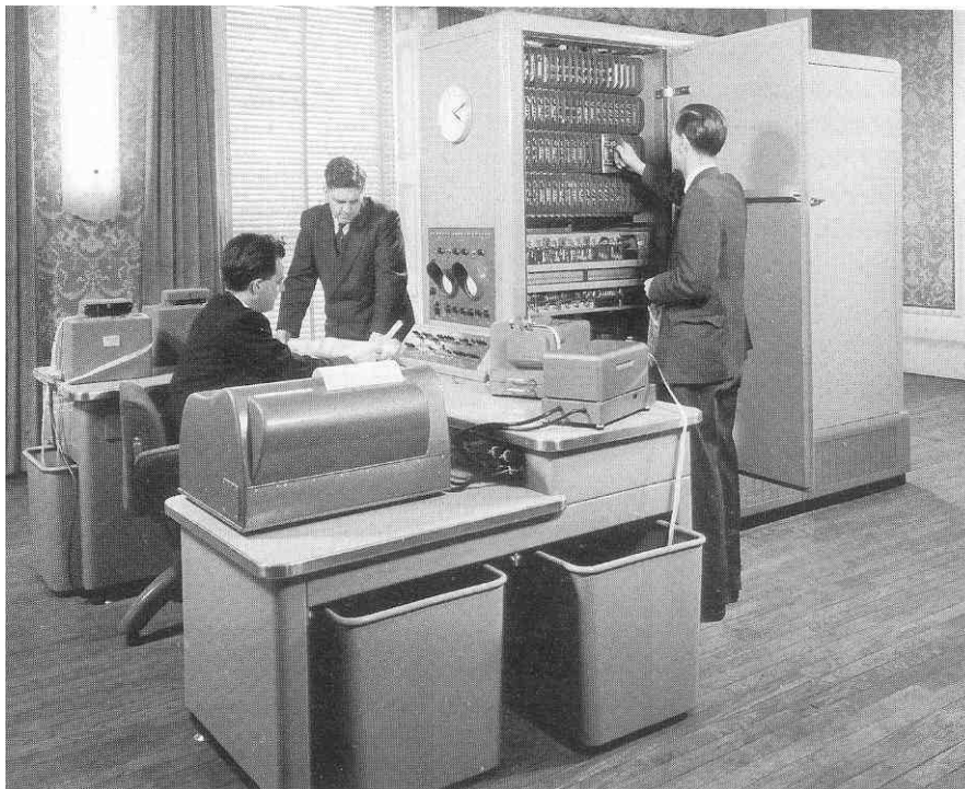
Abb. 14.9 Der erste Pegasus-Rechner. Links vorne die Konsole zur Bedienung
