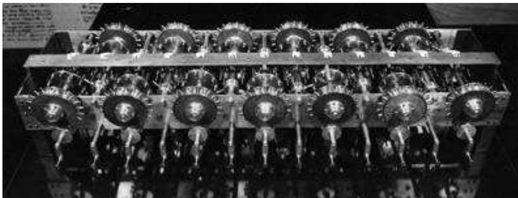
Abb. 7.3 Nachbau der Rechenmaschine von Leonardo da Vinci aus dem Jahre 1968
