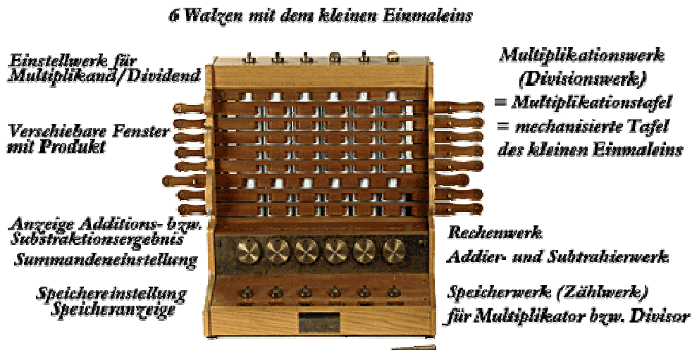
Abb. 7.10 Die Komponenten der Maschine
