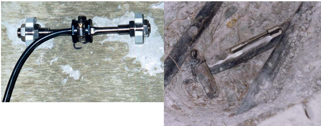
Figure 6 : Jauges de déformation à cordes vibrantes installées sur une surface de béton ou soudées sur une barre d'armature
