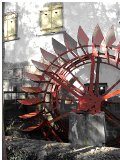
La roue à aubes courbes du moulin de Lütterbach (Alsace), à gauche ; une roue à aubes planes, extrait de l'Introduction à la mécanique industrielle de Poncelet, à droite.
