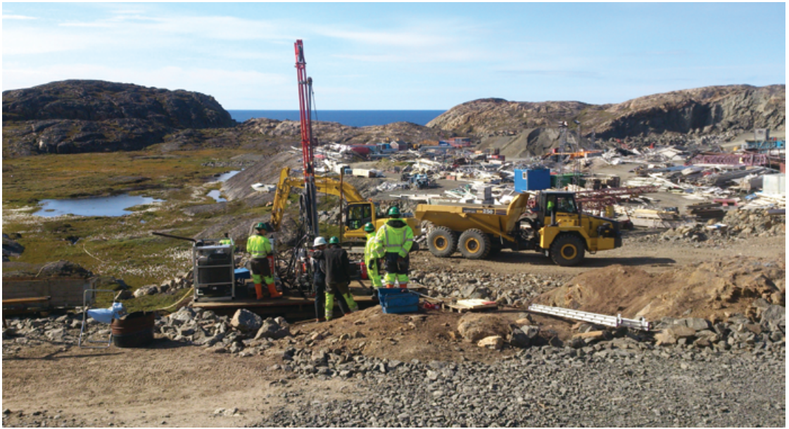
Boreplatform opsat i Råstofskolens prøvesprængningsområde, hvor de studerende får en forsmag på arbejdet i fremtidens grønlandske miner. (Foto: Elia Heilmann).
