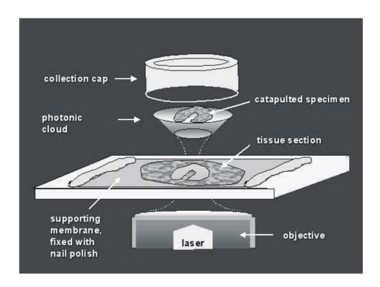
Abb. 14. Separierung von Chloroplasten aus einer Chloroplasten-Isolierung durch LMM und LPC (schematisch). Durch LMM ausgeschnittene Chloroplasten enthaltende Membran-Inseln werden durch LPC in ein Gefäß verbracht, in dem sie weiterverarbeitet werden können. (S. Thalhammer, mit freundlicher Genehmigung).
