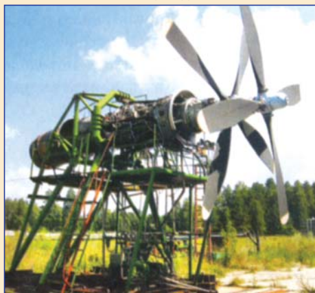
Двигатель НК-62 на испытательном стенде
