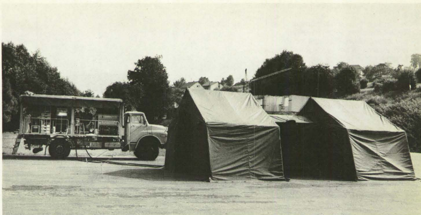
Bild 10: Aufgebaute Personen-Dekontaminations-Dusch- anlage.
