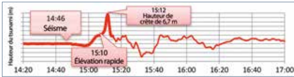
La bouée GPS ancrée par 204 m de profondeur au large du port de Kamaishi a enregistré à plus de 6 m la crête de la première vague du tsunami déclenché par le séisme survenu au large du Tohoku en 2011. Données obtenues par le Bureau des ports du Ministère japonais de l'aménagement du territoire, du transport et du tourisme (MLIT) et traitées par l'institut de recherche PARI
