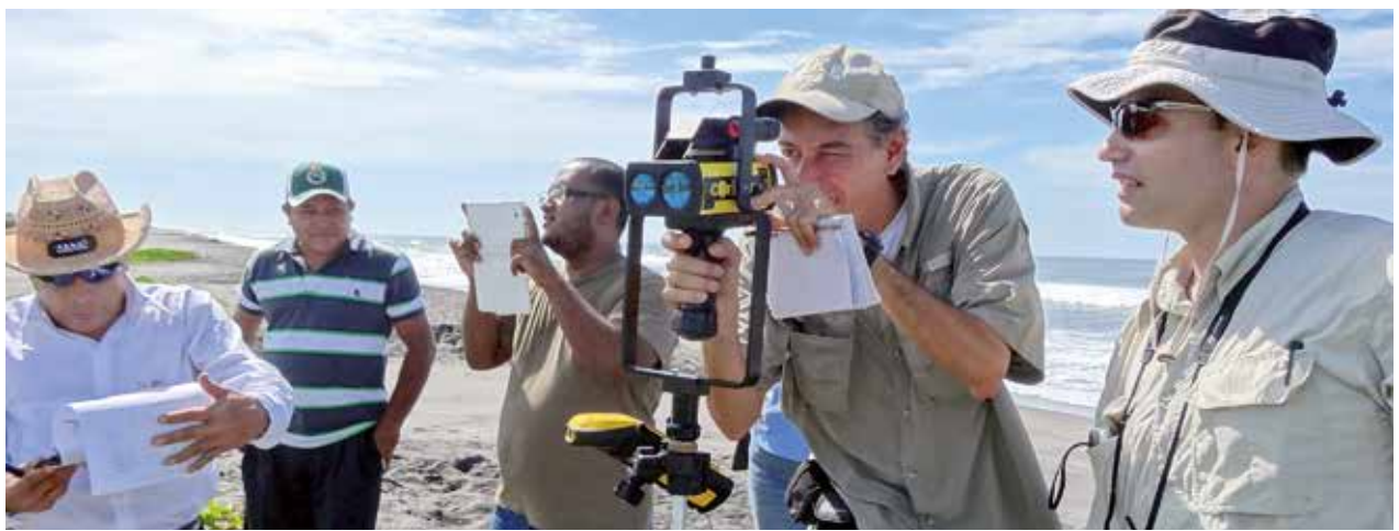
ITST mesurant le run-up d'un tsunami à l'aide d'un télémètre laser à El Salvador, 2012. Crédit photographique : CIIT
