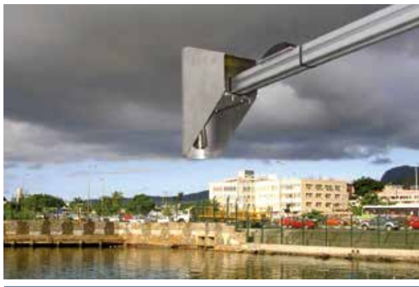
Les stations marégraphiques du GLOSS utilisent nombre d'instruments pour mesurer le niveau de la mer, notamment des radars orientés vers le bas. Port-Louis, à Maurice. Crédit photographique : Centre du niveau de la mer de l'Université de Hawaii
