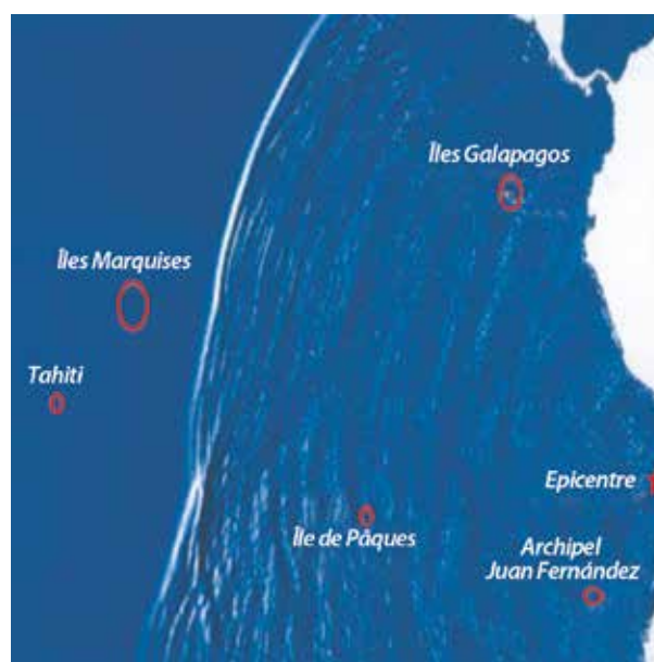
Modèle de propagation d'un tsunami dans le Pacifique Sud-Est, neuf heures après sa formation. Source : Antofagasta, Chili (30 juillet 1995). Avec l'autorisation du LDG-France
