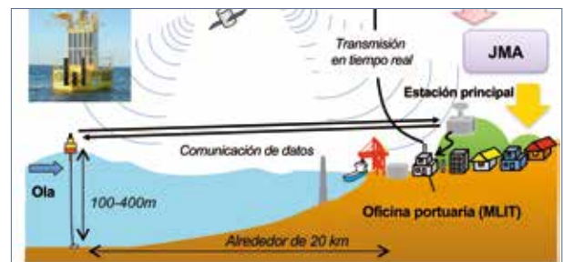
Sistema de boya georreferenciada para la vigilancia de olas y tsunamis introducido por el MLIT en 15 sitios alrededor de Japón.
