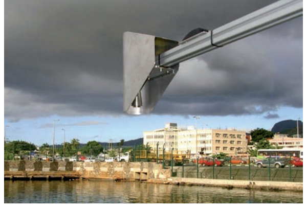
محطات قياس مستوى سطح البحر التابعة للنظام العالمي لرصد مستوى سطح البحر (GLOSS) تستخدم عدداً من الأجهزة لقياس مستوى سطح البحر، بما في ذلك الرادارات الموجهة إلى الأسفل بغية قياس مستوى سطح البحر؛ في بورت لويس بموريشيوس. تُستخدم هذه الصورة بإذن من مركز رصد مستوى سطح البحر التابع لجامعة هاواي.
