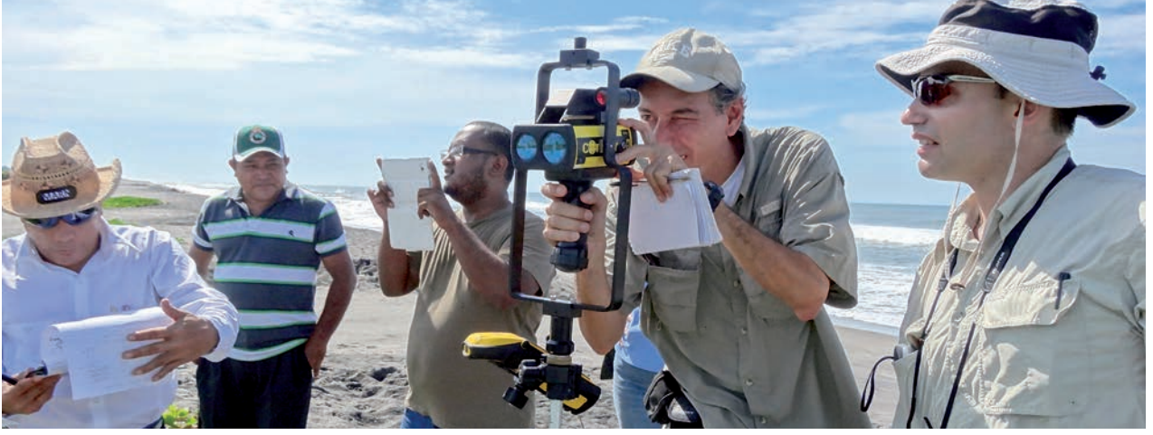
الفريق الدولي للدراسات الاستقصائية في مجال أمواج التسونامي يقيس اعتلاء أمواج التسونامي بواسطة جهاز ليزري لتحديد المدى في سلفادور عام ٢٠١٢. تُستخدم هذه الصورة بإذن من المركز الدولي للإعلام عن أمواج التسونامي (ITIC).
