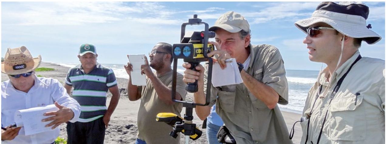
2012年国际海啸调查团在萨尔瓦多用激光测距仪测量海啸爬高。图片由国际海啸信息中心提供。
