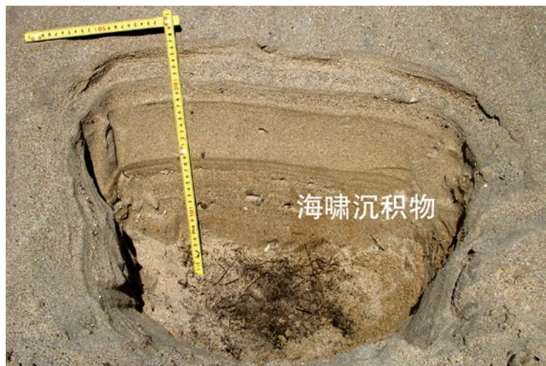
印度尼西亚班达亚齐观测到的2004年12月26日印度洋海啸连续波浪造成的沉积层。图片由日本北海道大学西村雄一提供。
