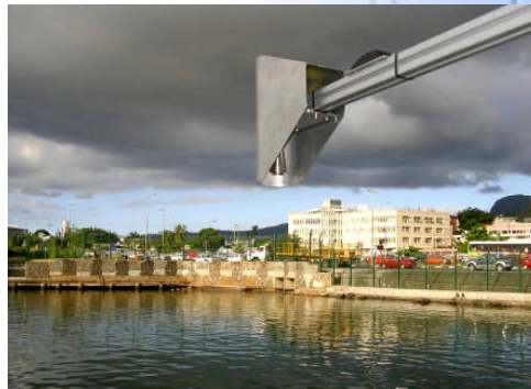
Stasiun-stasiun permukaan laut GLOSS menggunakan sejumlah alat untuk mengukur permukaan laut, termasuk radar-radar runduk untuk mengukur permukaan laut. Port Louis, Mauritius. Foto milik Pusat Permukaan Laut Universitas Hawaii.
