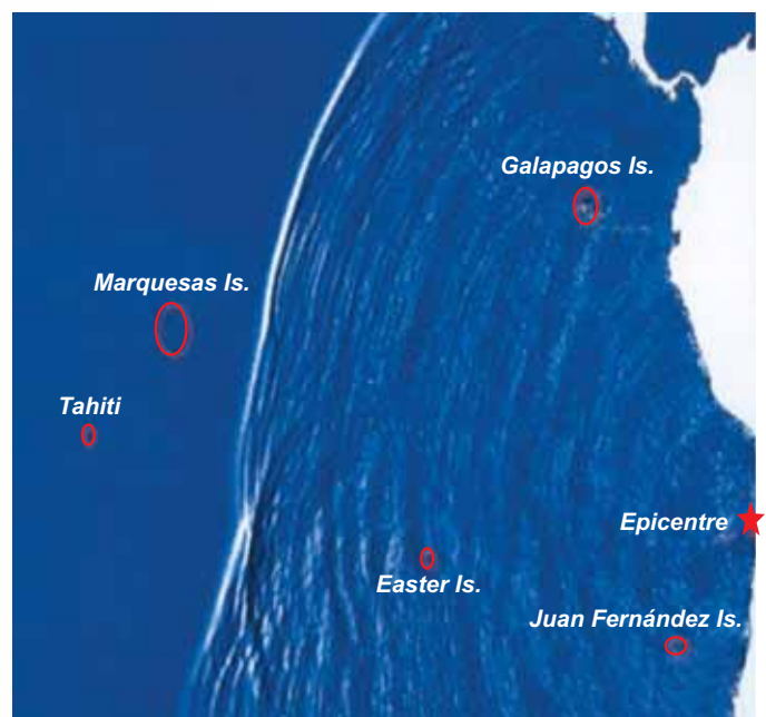
Modelo de propagación de un tsunami en el Pacífico sud este, nueve horas después de su generación. Fuente: Antofagasta, Chile (30 de julio de 1995). Cortesía de LDG, Francia.
