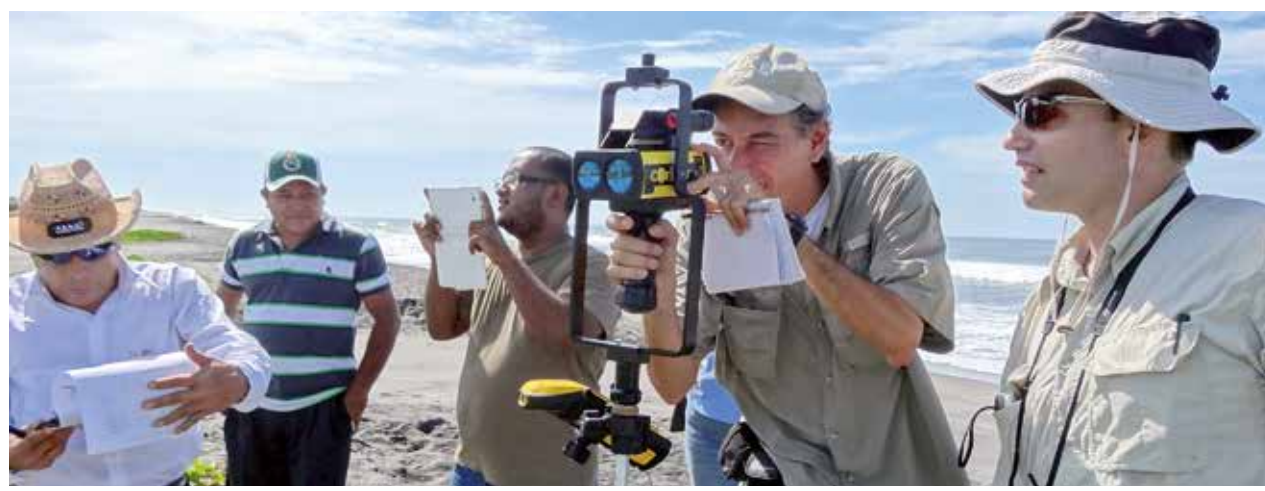
ITST midiendo el runup del tsunami con un telémetro láser en El Salvador en 2012. Fotografía por cortesía del ITIC.
