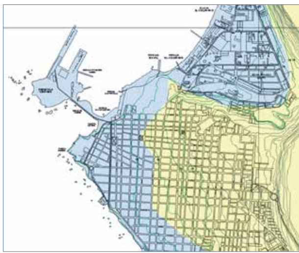
Inundación por tsunami estimada para Iquique (Chile) basada en resultados de una construcción de modelos numéricos. Cortesía del SHOA (Chile).
