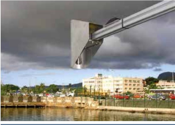
Las estaciones del nivel del mar GLOSS emplean muchos instrumentos para medir el nivel del mar, incluyendo radares invertidos. Port Louis (Mauricio). Fotografía por cortesía del Centro del Nivel del Mar de la Universidad de Hawái. Cortesía del Centro del Nivel del Mar de la Universidad de Hawái.
