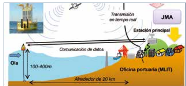
Sistema de boya georreferencial para la vigilancia de olas y tsunamis introducido por el MLIT en 15 sitios alrededor de Japón.
