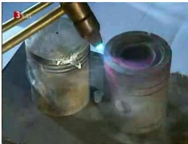
Abbildung 1: Gegenkolbendiesel mit Karbon-Aluminium-Kolben (Fotos: 3sat Sreenshots)
