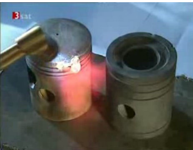
Abbildung 1: Gegenkolbendiesel mit Karbon-Aluminium-Kolben (Fotos: 3sat Sreenshots)
