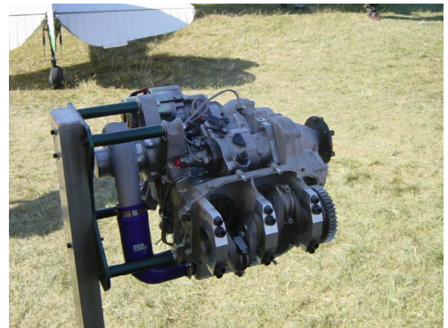
Abbildung 11: Diesel Air 100 ohne Kurbelwellenabdeckung (Foto: Diesel Air)
