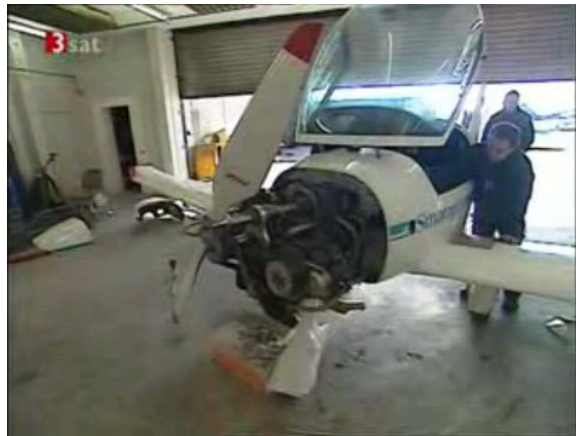
Abbildung 4: GKM 1200 im Ultraleichtflugzeug Smaragd (Foto: 3sat Screenshot)
