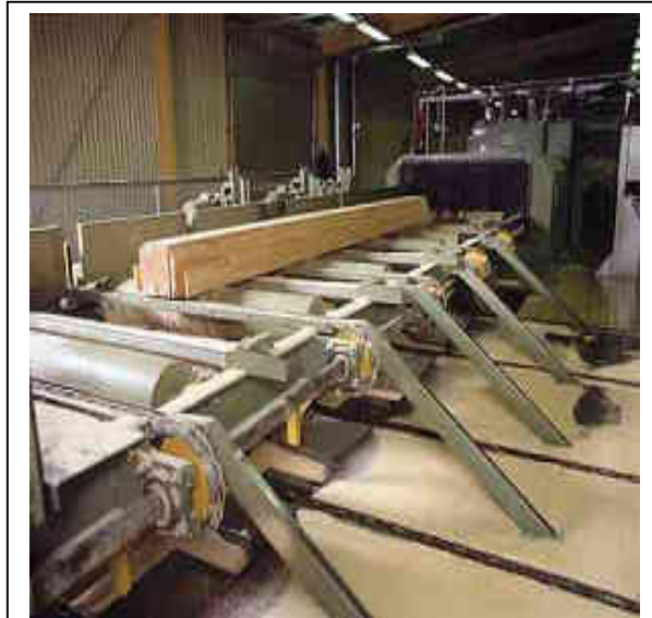
Αποφλοιώση και τεμαχισμός κορμοτεμαχιδίου
