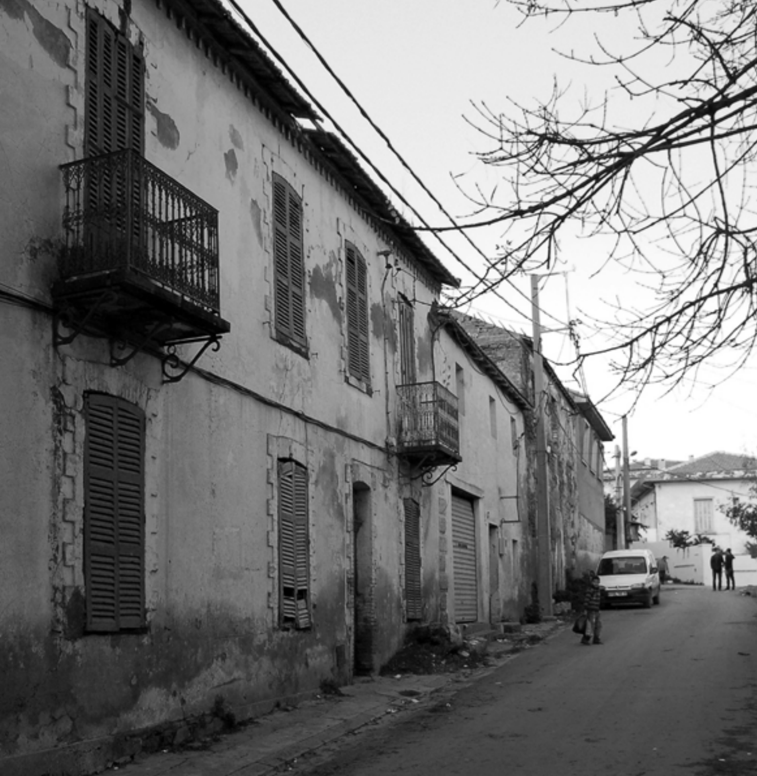
Rue de la ville coloniale proche de la partie haute de la casbah, avec succession de maisons en bande à plan et façade symétrique et petite cour arrière. Il s'agit d'une architecture très sobre et simple, en maçonnerie, caractérisée par un système d'ouverture cohérent composé de fenêtres et portes étroites et hautes de manière à réduire les discontinuités des corps de maçonnerie.
