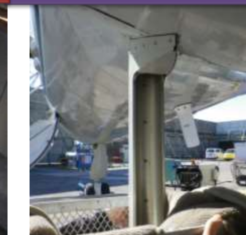
ドロップゾンデ投下装置(機外)
