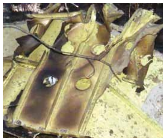
Pierwszy dźwigar lewego skrzydła z wyraźnie widocznymi osmoleniami i opaleniami na skutek wybuchu
