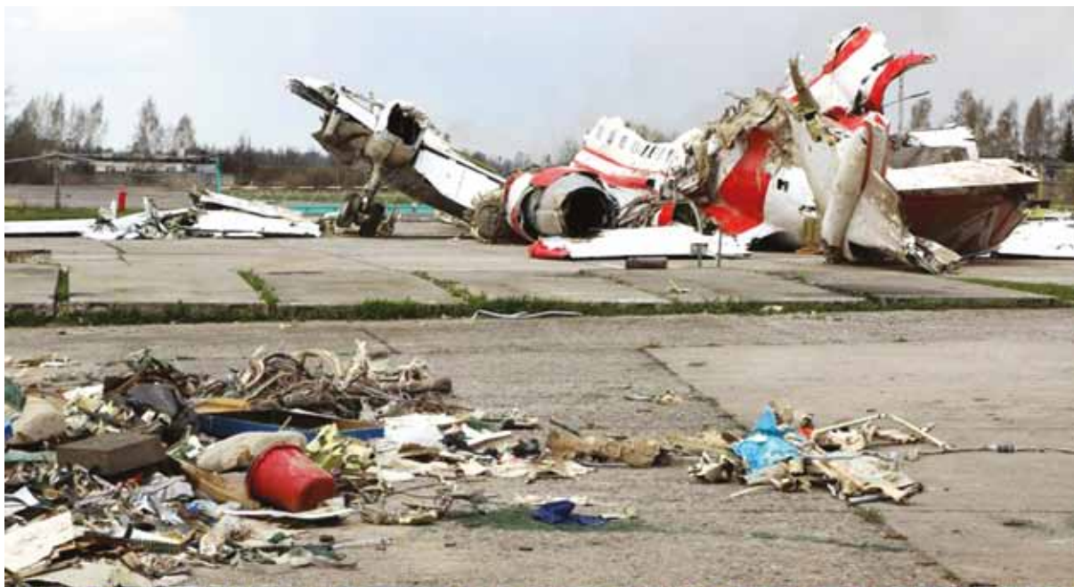
Rysunek 13. Duże części samolotu na betonowej powierzchni po transporcie z miejsca katastrofy.
