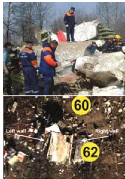
Rysunek 15. Lewa i prawa ściana odcięte od kadłuba w dniu 11.04.2010 r. Oddzielone ściany (białe strzałki) na zdjęciu z Raportu MAK.
