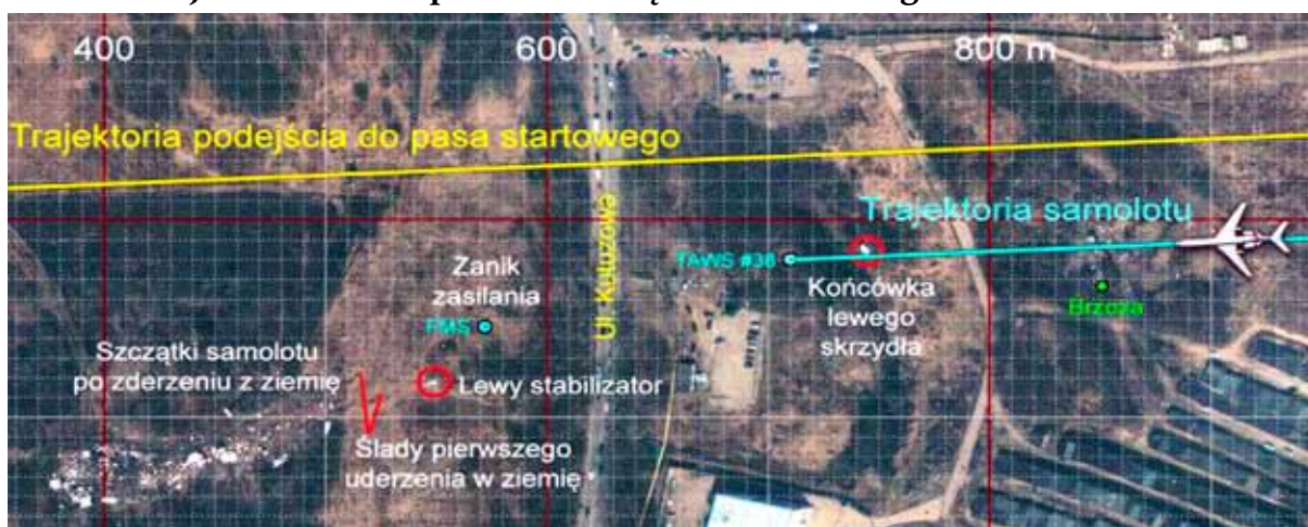
Rysunek 4. Trajektorja samolotu (linia błękitna) w porównaniu do osi drogi startowej (linia żółta). Mapa sporządzona przez K. Nowaczyka na podstawie raportu MAK (Załącznik VIII), zdjęcia satelitarnego (Załącznik VI) i raportu NTSB (Załącznik VII). Pozycje FMS i TAWS #38 pochodzą z ekspertyzy Universal Avionics NTSB (Załącznik X). Zanik zasilania na wysokości 15 m, 70 m przed pierwszymi śladami uderzenia w ziemię.
