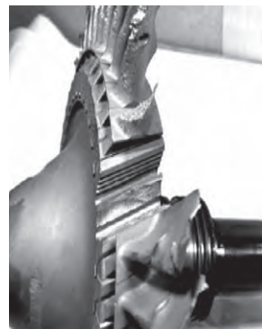
図7.2 TPL 過給機の低サイクル疲労破壊試験 (1)
