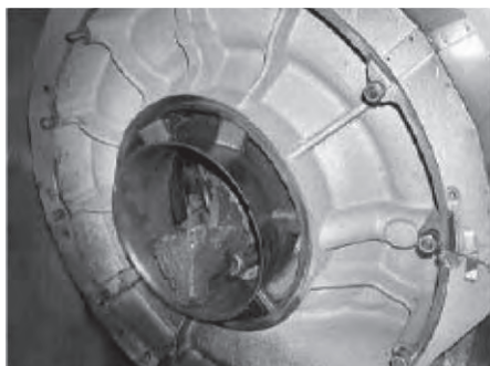
図 7.6 ABB TPL 過給機圧縮機羽根車の破壊試験 (1)
