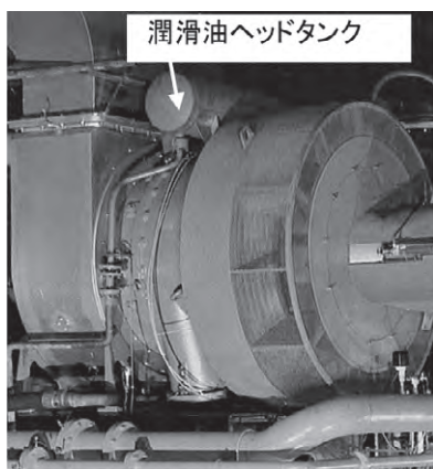
図 8.6 NA-T 過給機上部の潤滑油ヘッドタンク MAN 過給機カタログ
