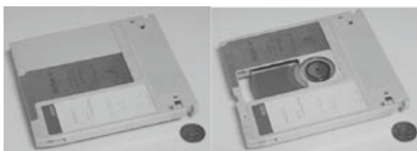
図 5.1 ISO9171 型 130mm 光ディスクカートリッジ (同一外観の書込型の写真) (シャッター閉(左)と開(右)、チャッキング・ハブは磁気吸引式、 右下はスケール用十円玉) (出典：著者撮影)
