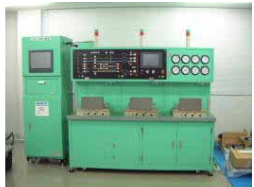
(空気弁自動試験機) 空気制御用の各種空気弁を自動的に試験
