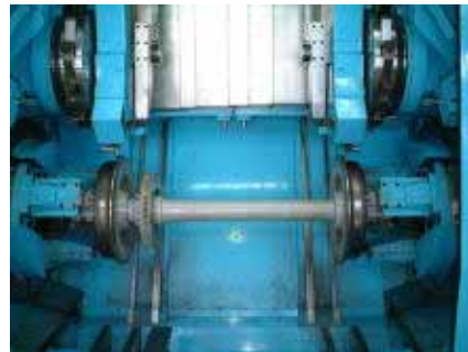
車輪旋盤の内部
