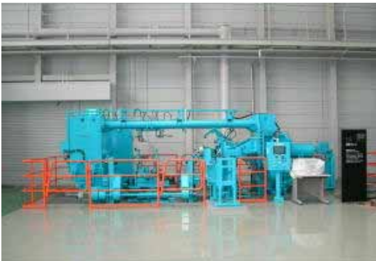
(輪軸プレス) 使用限度がきた車輪を取りはずし、新しい 車輪を取り付ける
