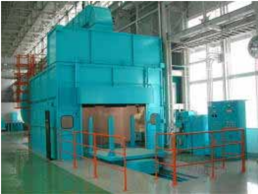
(台車塗装装置) 台車枠の塗装用
