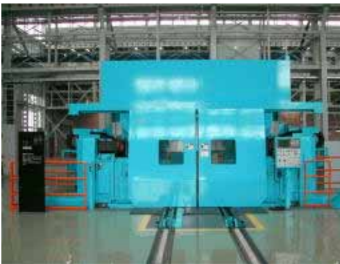
(車輪旋盤) 一定期間走行した車輪を定期的に削正 車軸に車輪、ブレーキディスクを取り付けたままで削正
