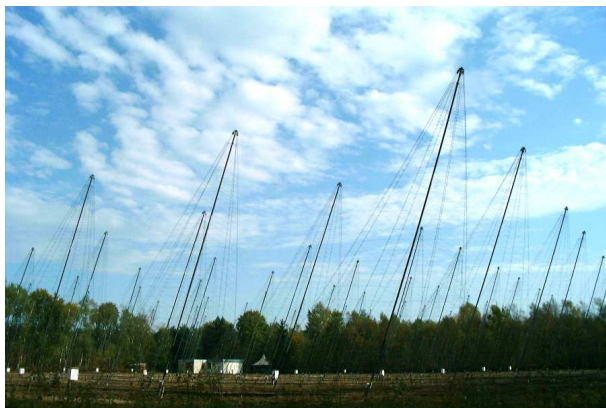
FIG. 1.12 – Les antennes log-spirales fixes du réseau décamétrique de Nançay. La direction de visée est fixée par le déphasage des signaux provenant des antennes. Les pylônes sont pointés vers l'élévation moyenne de passage des sources étudiées (Soleil, Jupiter).
