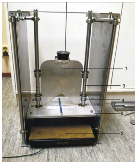
Foto 2. Katseseade liha lõikeenergia määramiseks gravitatsioonilise impulssmeetodiga (1 – lõiketera, 2 – jõuanduri platvorm, 3 – juhtvardad, 4 – liuglaager, 5 – lõikelaud) (L. Lepasalu)
