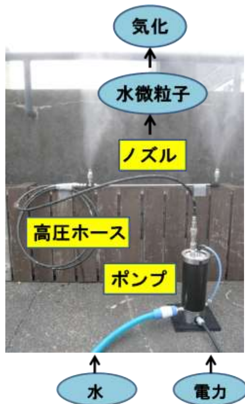
写真 2-1 ドライミスト装置の構成
