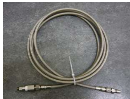
写真 2-3 高圧ホース拡大写真
