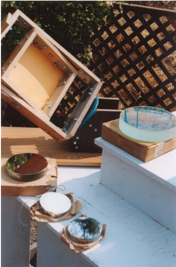
Abb. 1: Heliostat mit Spiegeln: \varnothing 200 mm, \varnothing 150 mm (5 m Brennweite) und 2 x \varnothing 106 mm (je 5 m Brennweite)
