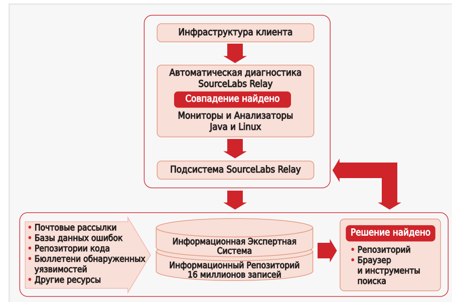
Рис. 4. Архитектурная диаграмма системы технической поддержки в режиме самообслуживания
