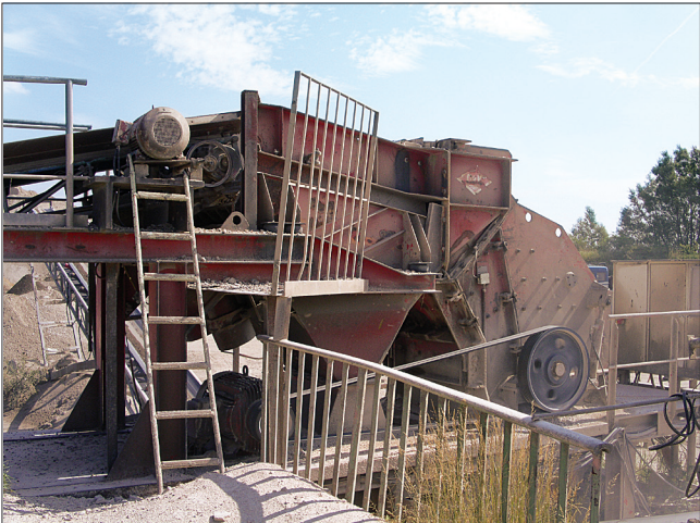
Bild 3: Prallbrecher zur Aufbereitung
