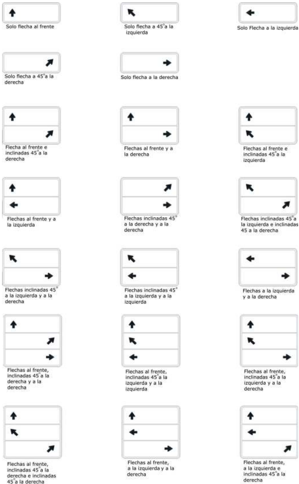
FIGURA 1.9-4 DISPOSICIÓN DE FLECHAS EN SEÑALES INFORMATIVAS LATERALES
