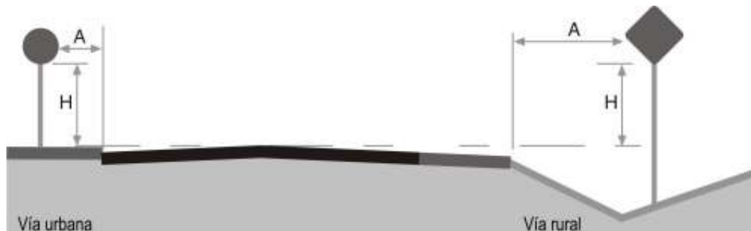
FIGURA 4.3-4 UBICACIÓN SEÑALES VERTICALES EN ÁREA DE ADVERTENCIA
