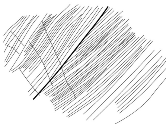
Abb. 28: Skizze zur Schrägschichtung in Abb. 27. Die fette Linie markiert den erosiven Kontakt zwischen zwei sich überlagernden Gerinnen. Im linken Aufschlussbereich durchziehen Klüfte das Gestein (T. KASIELKE).
