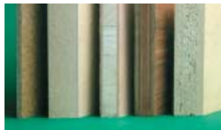
Bild 20: Beispiele für plattenförmige Holzwerkstoffe; v. l. Hartfaserplatte, MDF; Tischlerplatte, Furniersperrholz, Spanplatte.
