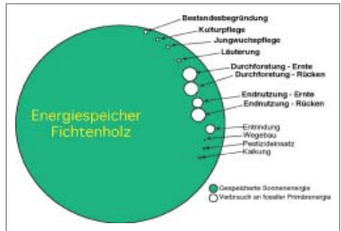
Bild 8: Verbrauch von Primärenergie für die einzelnen Produktionsschritte einer intensiven Forstwirtschaft zur Bereitstellung von Fichten-Stammholz im Verhältnis zur im Holz gespeicherten nutzbaren Energie (Heizwert H_u ).
