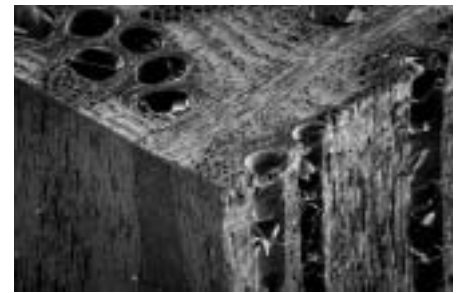
Bild 12: Rasterelektronenmikroskopische Aufnahme von Eichenholz.
