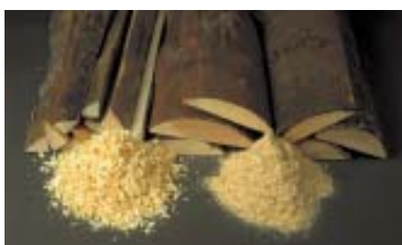
Bild 19: Nebenprodukte und Resthölzer der Sägeindustrie: Schwarten, Späne und Sägemehl als Rohstoffe für Holzwerkstoffe.
