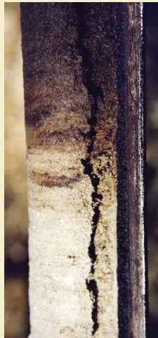
Bohrkern mit Übergang von der Kalkmudde zum Niedermoor торf (Fotos: J. Zeitz)
