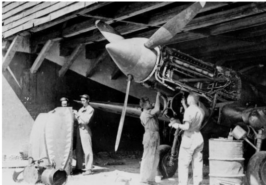
图 3.8 29 : 飞虎队机械员正在修理 P-40 型战机 (1942 年)。
