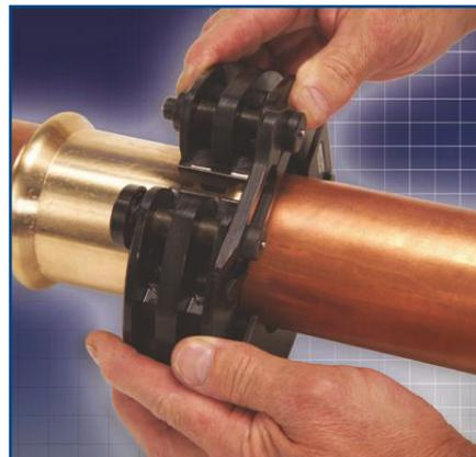
Sitz zwischen Nut der Schlinge und Fitting-Sicke prüfen. Die Stützplatte der Schlinge muss über das rohreseitige Ende der Verbindung passen.
