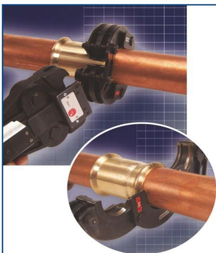
Zur vollständigen Verpressung einer 108 mm-Verbindung muss der Fitting immer zwei Pressvorgängen unterzogen werden!
