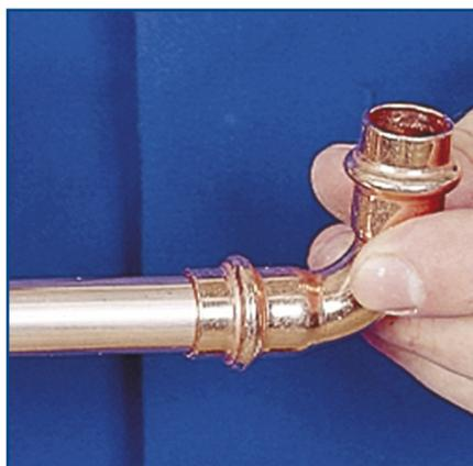
Das Rohr wird unter Beachtung der vorab angebrachten Einstecktiefenmarkierung bis zum Rohranschlag in den Fitting eingeführt.
