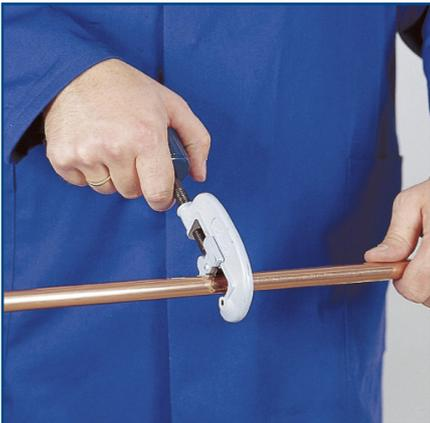
Kupferrohre sind vorzugsweise mit einem Rohrab-schneider, alternativ mit feinzahnigen Bügelsägen oder speziellen elektrischen Rohrsägen recht-winklig abzulängen.
