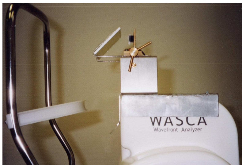
Abbildung 3.9: Foto der Seitenansicht von WASCA mit Targetaufsatz (das Nahziel ist aktiviert)
