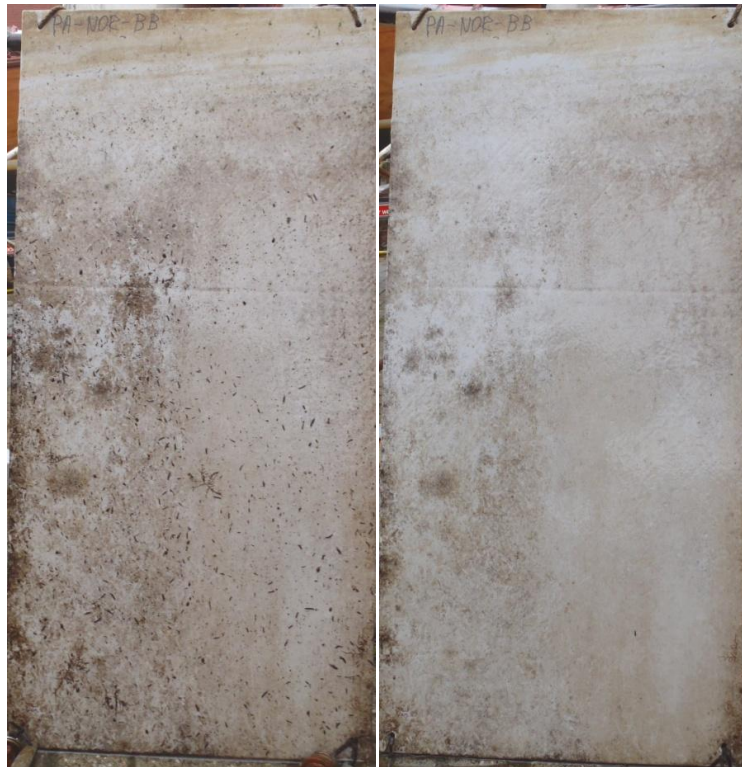
Abb. 27: Komplette Reinigung der Panadur-Platte mit der Beckmann Bürste (BB) am Norder Tief bei der dritten Reinigung am 5. Oktober. Links vor der Reinigung, rechts danach.
