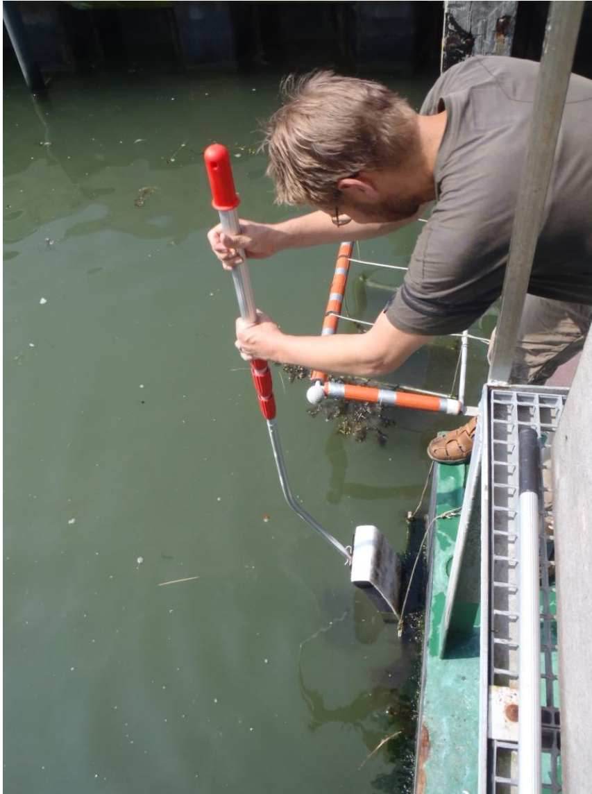
Abb. 8: Anwendung des Big Easy Cleaner BEC auf Testplatten.
