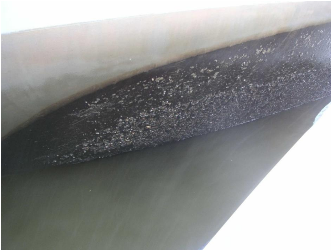
Abb. 102: Inspektion 6, der vordere Rumpfbereich des Segelbootes Makowski war stark bewachsen mit Zebrauscheln und Schwämmen.
