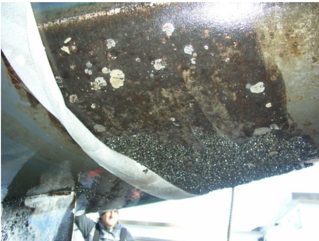
Abb. 108: Endinspektion am 07.11.2013, Sawatzki, Bewuchs auf den nicht beschichteten Flächen mit Schwämmen, Zebamuscheln und dichtem Biofilm.
