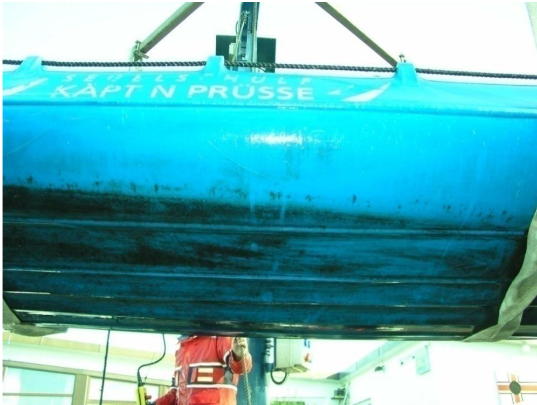
Abb. 94: Inspektion 5, King Louis Rumpf nach Reinigung mit Hochdruckwascher, 150 bar.
