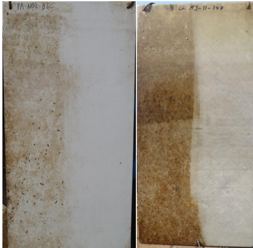
Abb. 31: Halbseitige Reinigung der Platten mit dem Big Easy Cleaner am Norder Tief bei der zweiten Reinigung am 14. August (links Panadur, rechts WEST).
