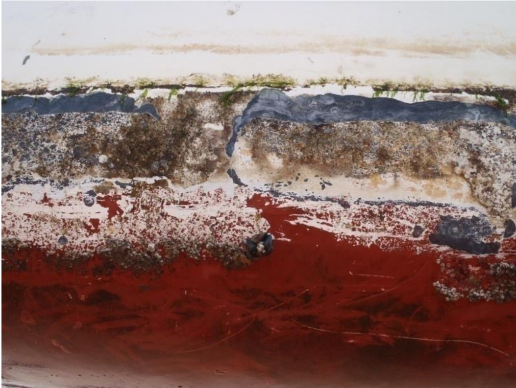
Abb. 79: Windsbraut steuerbord: Auch einige Miesmuscheln blieben nach der Reinigung auf dem Rumpf haften.
