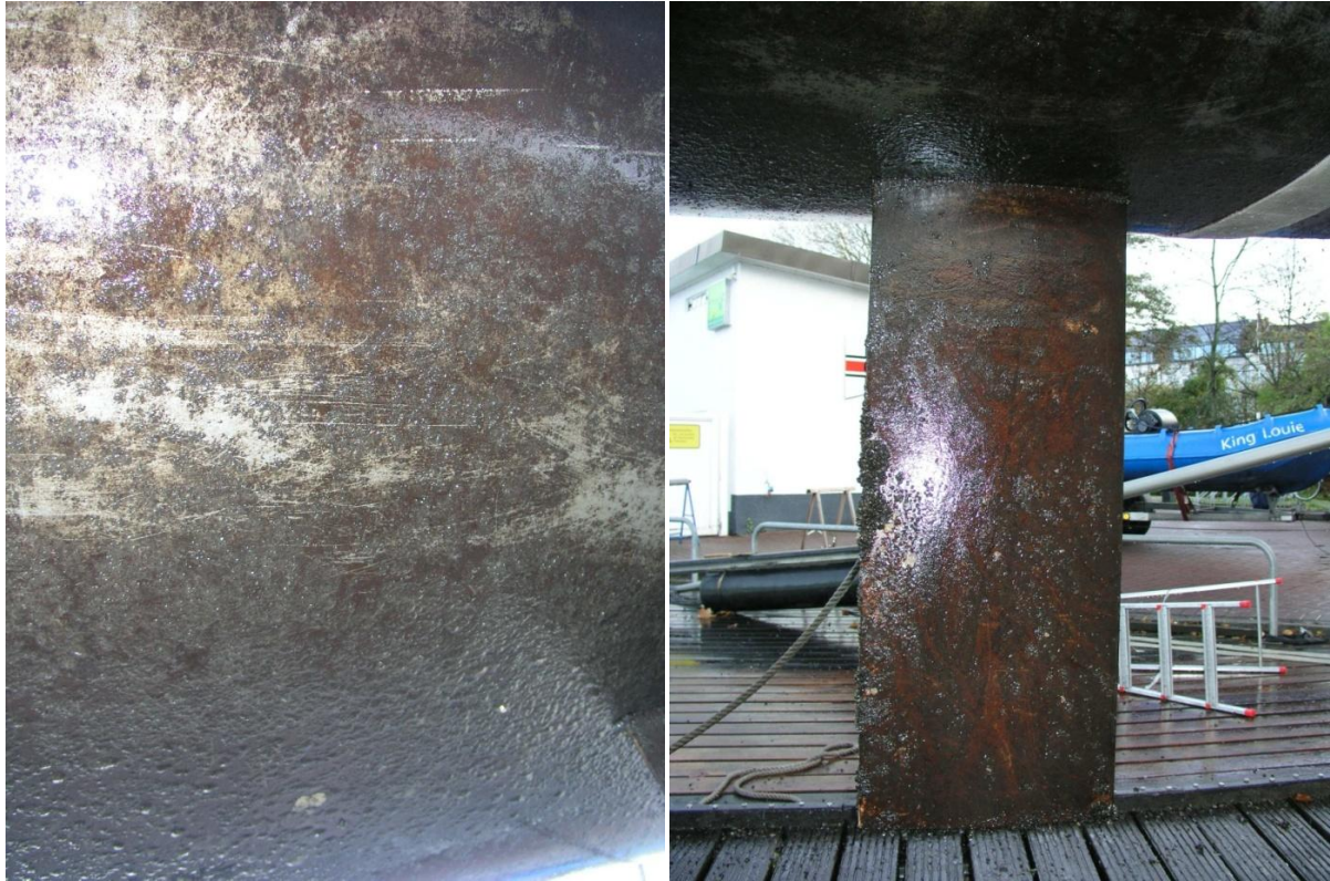
Abb. 107: Segelboot Makowski, links, Nahansicht des Bewuchses aus Brackwasserpolyphen und flächigem Biofilm vor der abschließenden Reinigung, rechts, Bewuchs auf dem Schwert vor der abschließenden Reinigung; vereinzelt Bündel aus Zebamuscheln, Brackwasserpolyphen und flächigem Biofilm.
