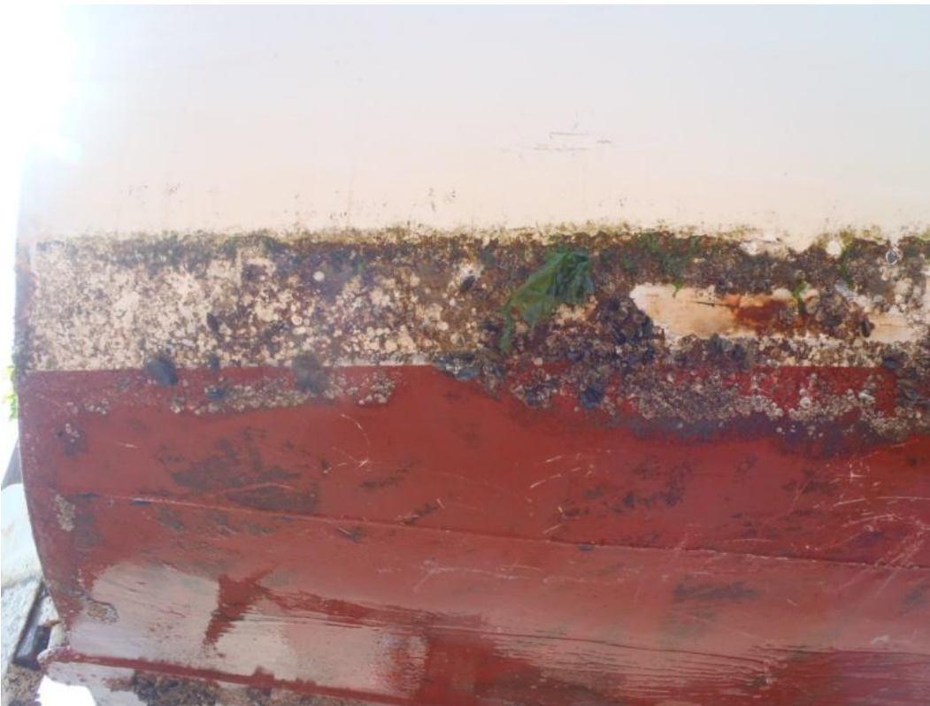
Abb. 78: Windsbraut steuerbord: Seepocken und Algen wurde nicht vollständig entfernt.
