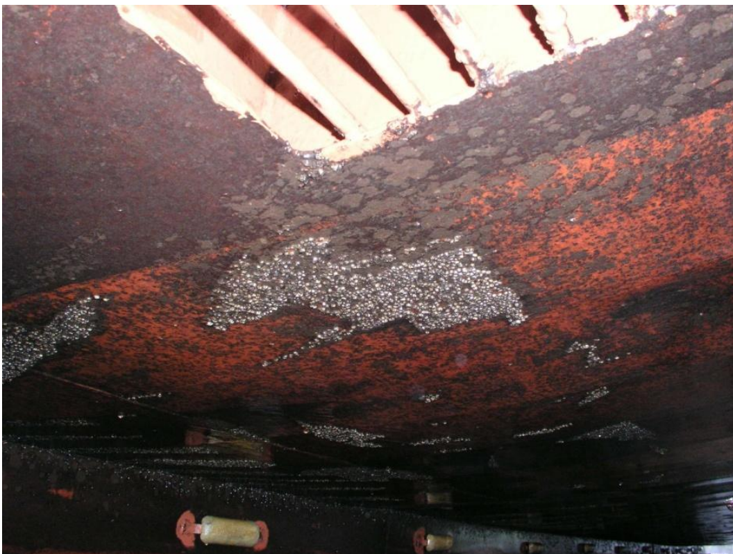
Abb. 89: Dichter Seepockenbewuchs auf den Pallenflächen der vorhergehenden Dockung.
