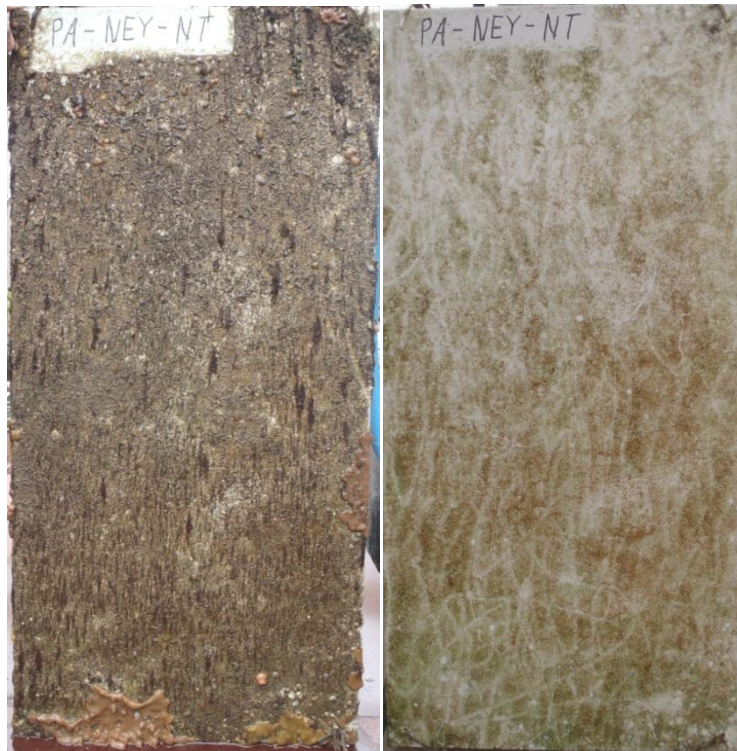
Abb. 49: Panadur Testplatte bei der zweiten Inspektion vor und nach der Reinigung mittels Caviblaster.
