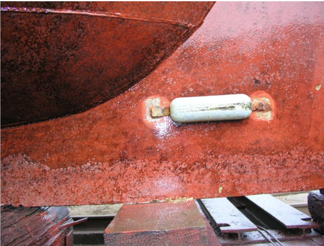
Abb. 87: Bug Nahansicht nach der Reinigung: Einige Basalplatten von Seepocken waren nicht entfernt worden.
