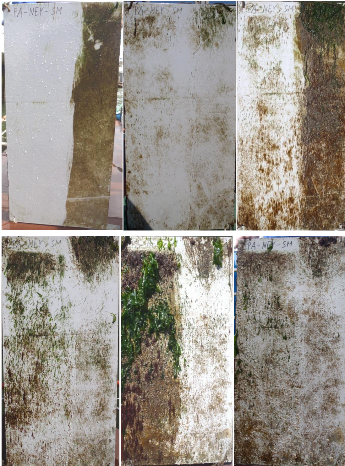
Abb. 40: Abwechselnd halbseitige und komplette Reinigung der Panadur-Platte mit dem Scrubmarine im Norderneyer Hafen von der ersten Reinigung (links oben) bis zur letzten am 18. September (rechts unten).
