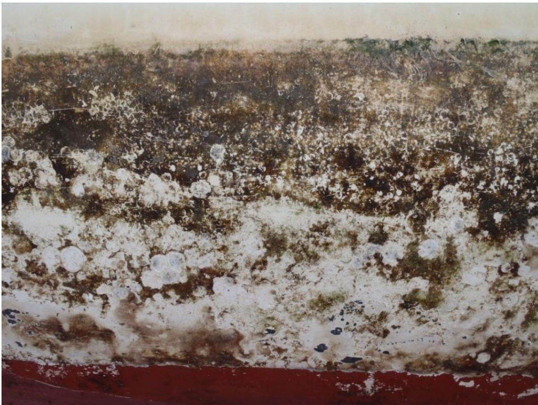
Abb. 75: Windsbraut: Nahaufnahme der Backbord-Seite gereinigt durch den Taucher. Der Makrobewuchs wurde weitgehend entfernt, der Biofilm nicht.
