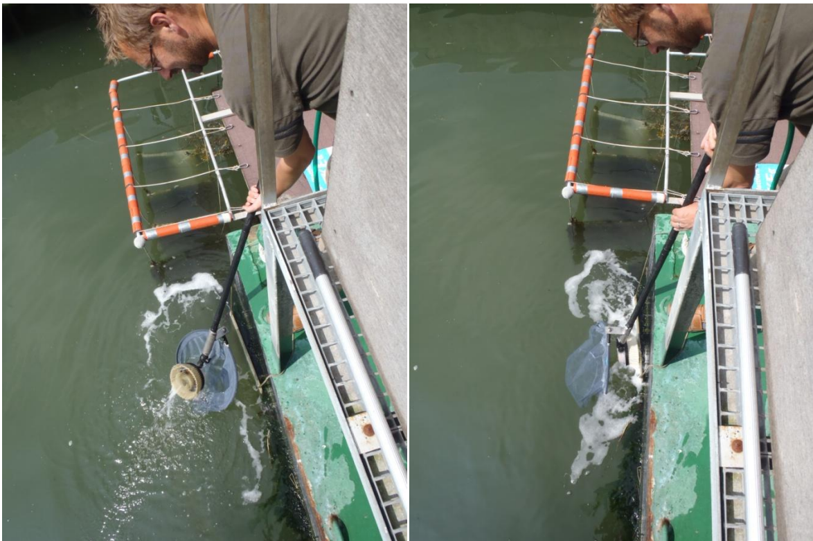
Abb. 5: Rotierende-Waschbürste von Beckmann mit Auffangkorb und rotierendem inneren Bürstenkranz.
