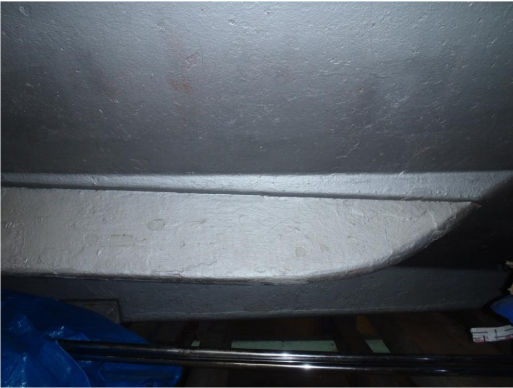
Abb. 122: Stabilisatoren unter der Wasserlinie verhindern eine Reinigung.
