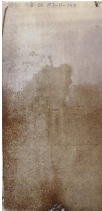
Abb. 32: Komplette mit dem Big Easy Cleaner gereinigte WEST-Platte am Norder Tief bei der dritten Reinigung am 5. Oktober.
