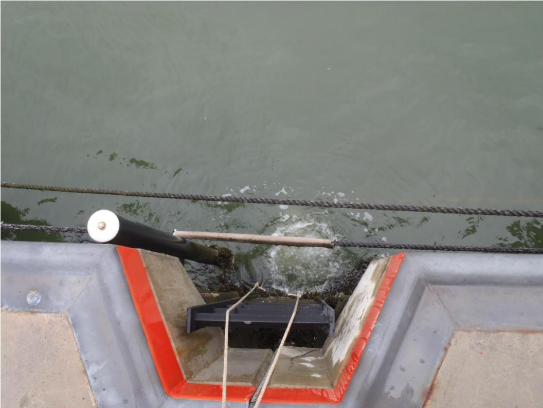
Abb. 19: Reinigung einer Testplatte mit dem Caviblaster ca. 1 m unterhalb der Wasseroberfläche.
