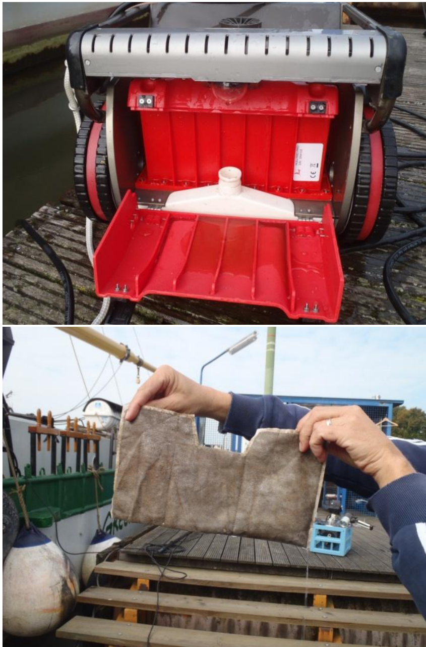
Abb. 82: Aufangvorrichtung für den Auffangbeutel, oben. Aufgefangener Bewuchs nach Rumpfreinigung, unten.
