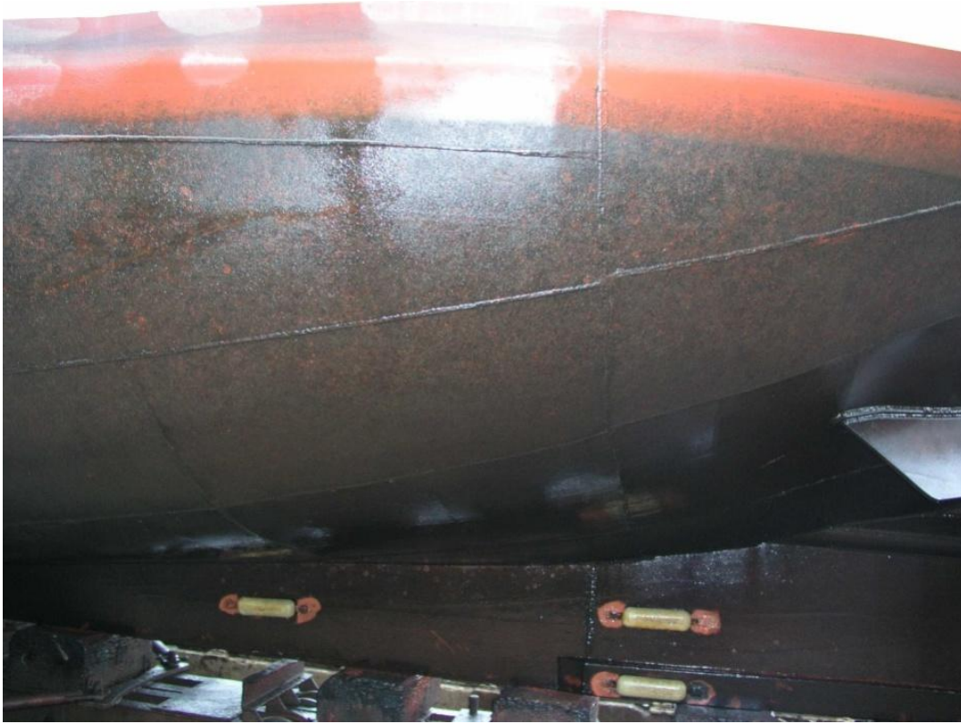
Abb. 88: Bugbereich Backbord, dichter Algenbewuchs.
