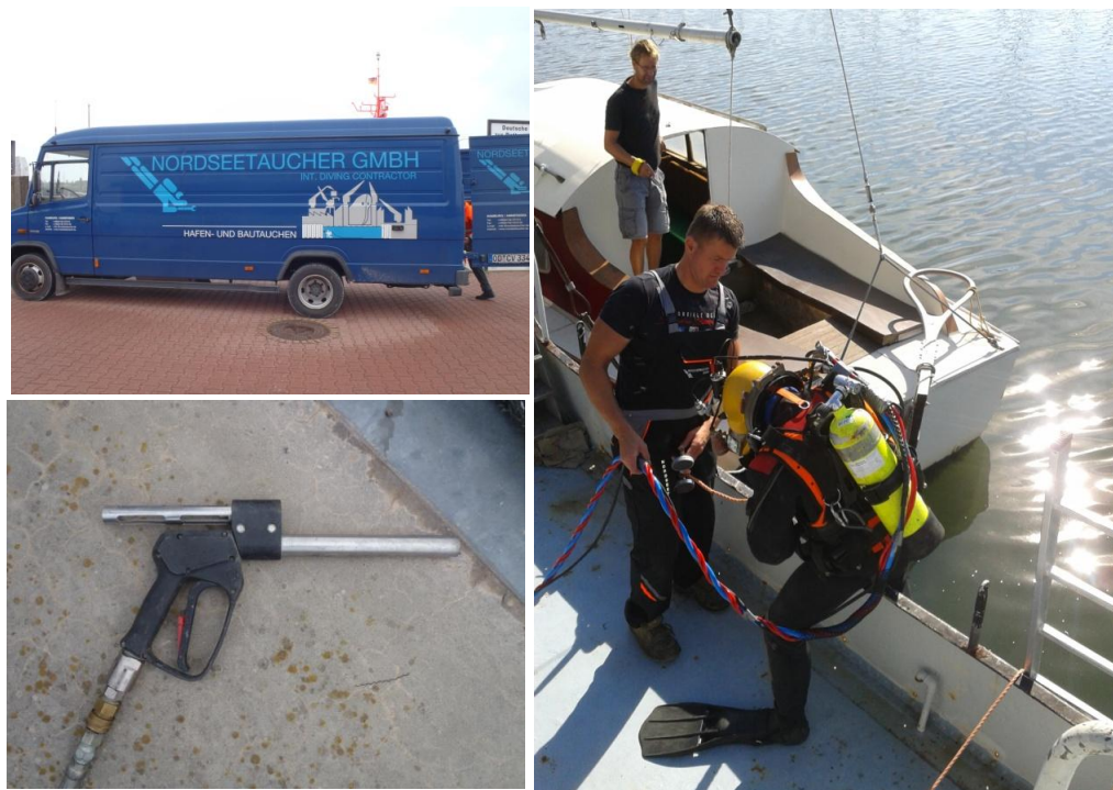
Abb. 76: Oben: Materialwagen der Nordseetaucher, unten: Cavitationspistole des Caviblasters™, rechts: Taucher mit Ausrüstung.
