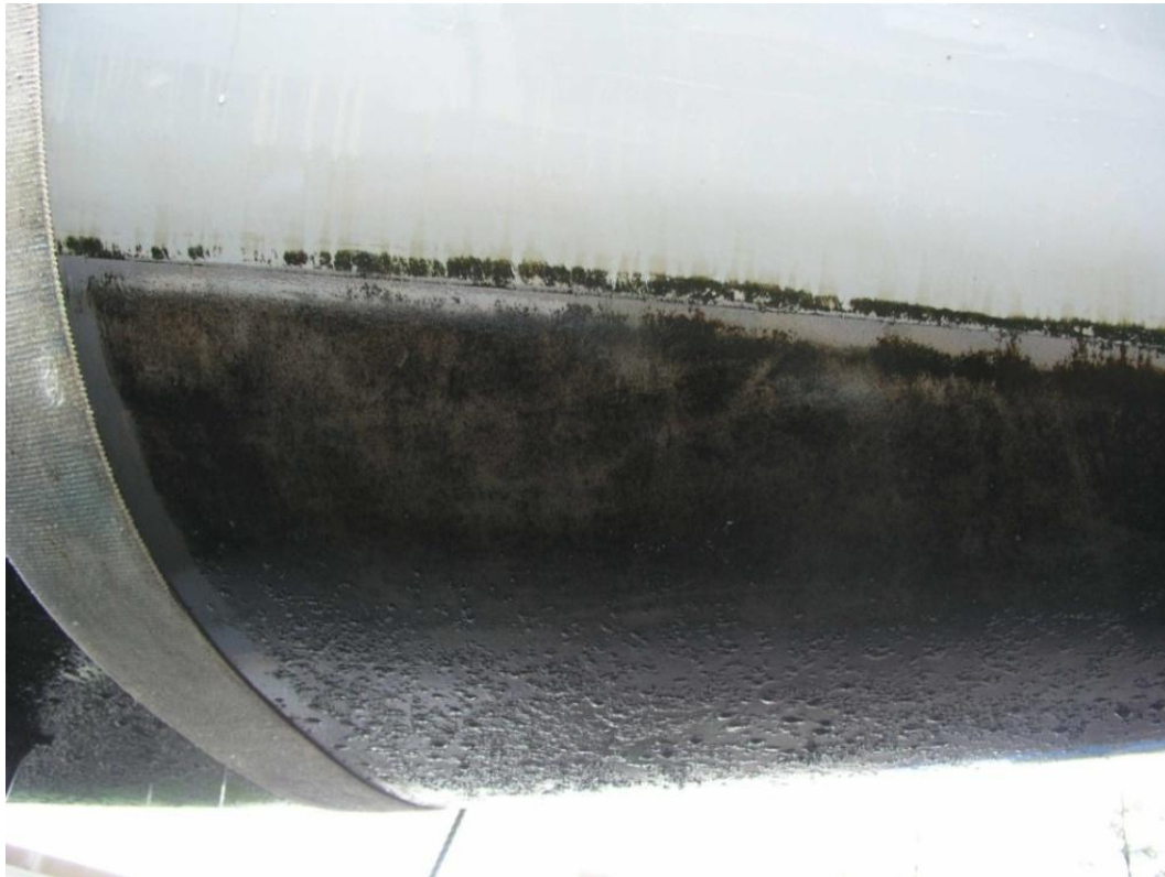
Abb. 106: Inspektion 8, Segelboot Makowski: Bewuchs aus Brackwasserpolypen und flächigem Biofilm vor der abschließenden Reinigung.
