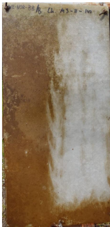
Abb. 26: Halbseitige Reinigung der WEST-Platte mit der Beckmann Bürste (BB) am Norder Tief bei der ersten Reinigung am 21. Juni (Foto der zweiten Inspektion nach der Reinigung fehlt).
