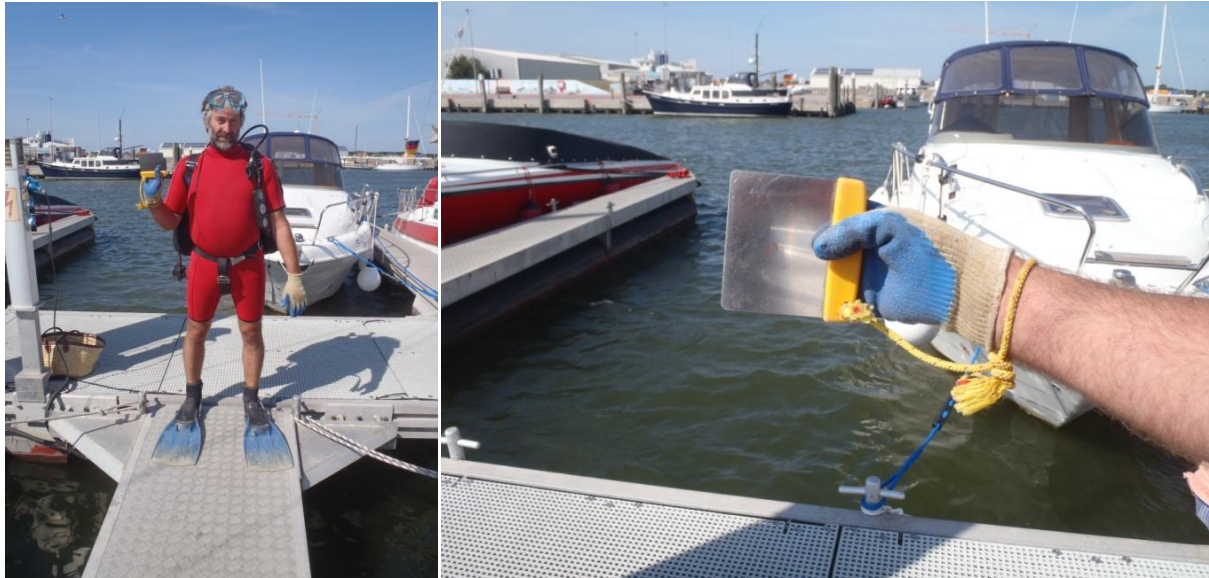
Abb. 73: Taucher H. Jakobs, Reinigungsgerät: Spachtel aus rostfreiem Blech.
