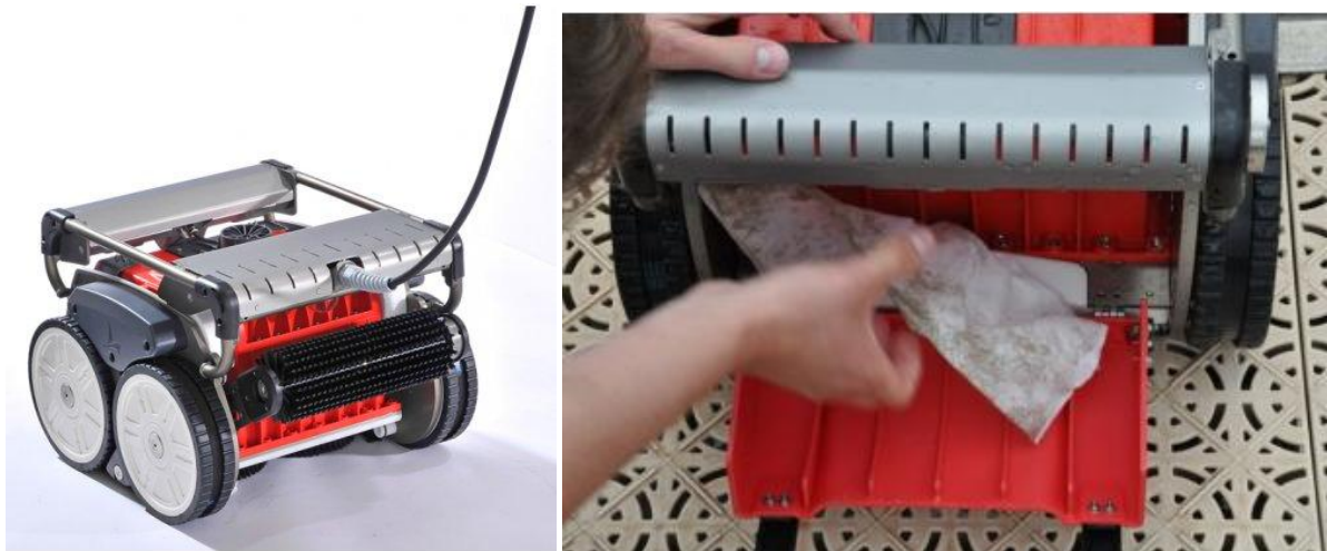
Abb. 67: Der Hulltimo Pro; Steuerung über eine Fernbedienung, rechts unten: Beutel mit aufgefangenem Bewuchs.
