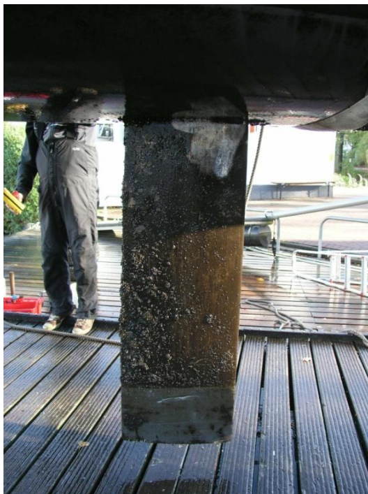
Abb. 110: Endinspektion am 07.11.2013, Schwert der Sawatzki mit Bewuchs aus Zebrauscheln, Brackwasserpolyphen und Biofilm.
