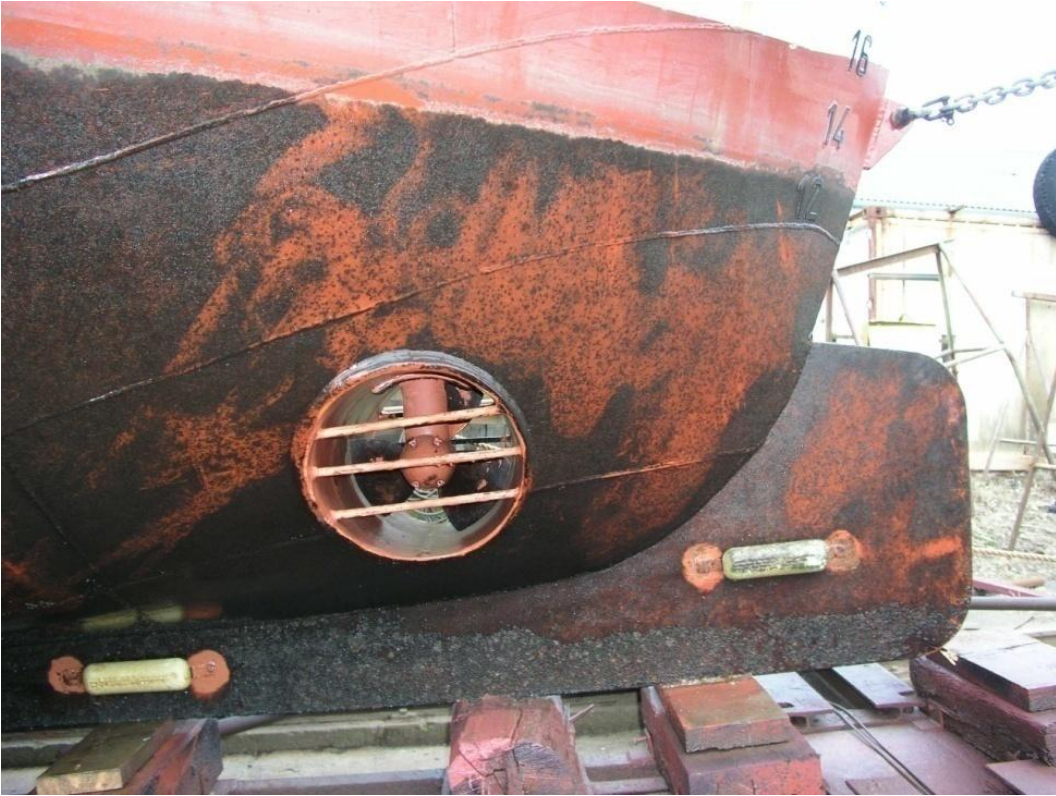
Abb. 86: Bug mit Steven und Querstrahlruder. Fleckiger Grünalgenbewuchs und dichter Seepockenbewuchs am Steven.
