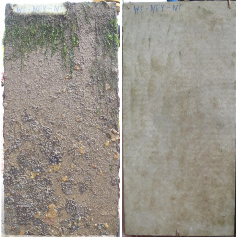
Abb. 51: Testplatte mit WEST SYSTEM bei der ersten Inspektion vor und nach der Reinigung mittels Caviblasten.
