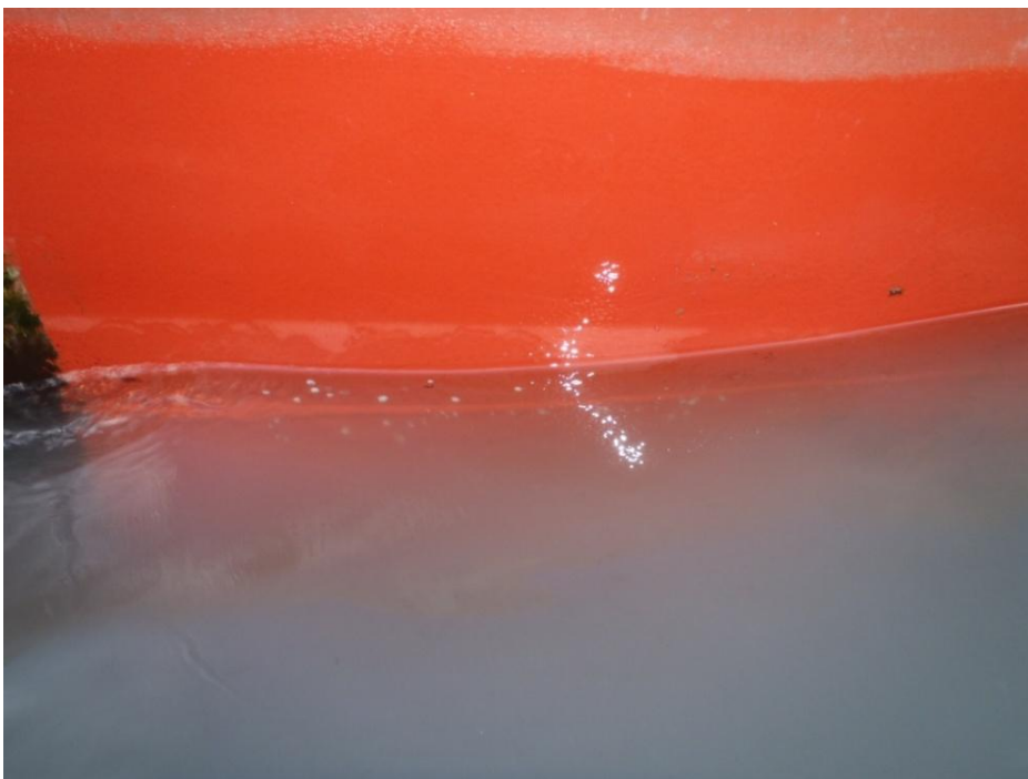
Abb. 71: Jotun „Sealion Resilient“ Testfläche nach der Reinigung mit dem BEC. Vereinzelt Seepocken blieben dennoch haften.
