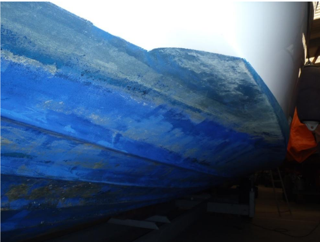
Abb. 123: Motorboot mit „Überstand“ und Kimmstringern. Der Überstand unter der Wasserlinie verhindert auch die Reinigung mit der Motorbootvariante des BEC.
