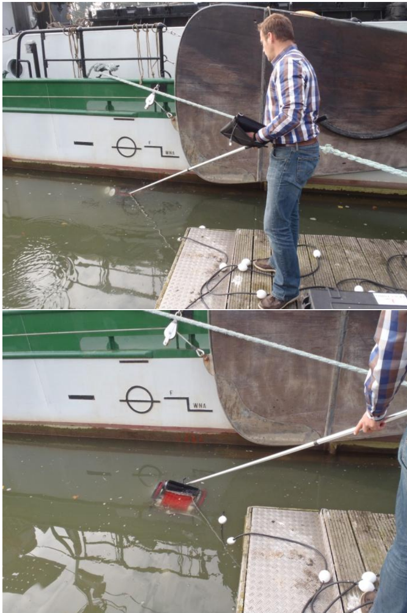
Abb. 80: Mitarbeiter der Firma von der Linden mit Fernbedienung, oben. Mit der Lenkstange wird der Roboter Hulltimo Pro in die richtige Position am Schiffsrumpf gebracht, unten.
