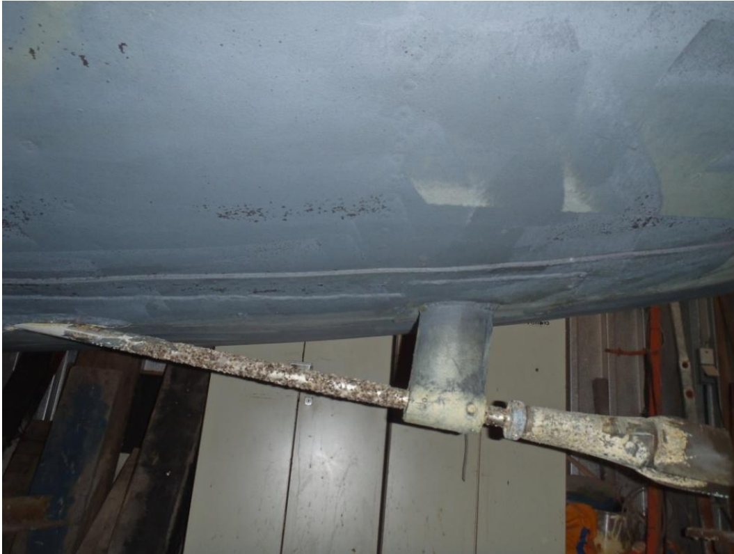
Abb. 124: Außen liegende Wellen z.B. bei Jollenkreuzern verhindern die Reinigung mittels Tausendbein im Heckbereich. Hier könnte alternativ oder zusätzlich der BEC eingesetzt werden, um den Bereich über der Welle zu reinigen.
