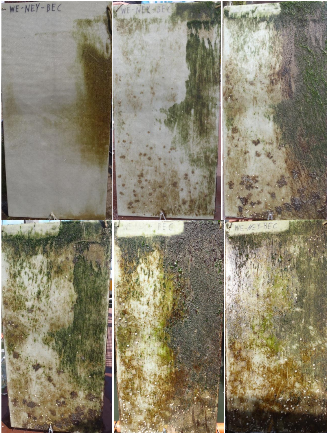
Abb. 34: Abwechselnd halbseitige und komplette Reinigung der WEST-Platte mit dem Big Easy Cleaner im Norderneyer Hafen von der ersten Reinigung (links oben) bis zur letzten am 18. September (rechts unten).
