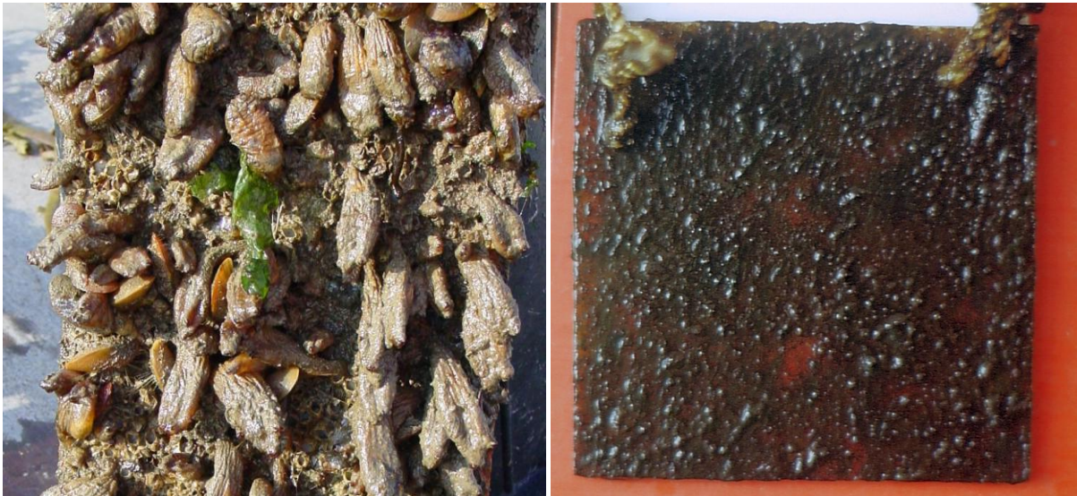
Abb. 3: Unterschiede in Bewuchsstärke und -Zusammensetzung zwischen einem marinen Standort (links: Norderney, Nordsee 2004) und einem limnischen Standort (rechts: Duisburg, Sechs-Seen-Platte 1997).
