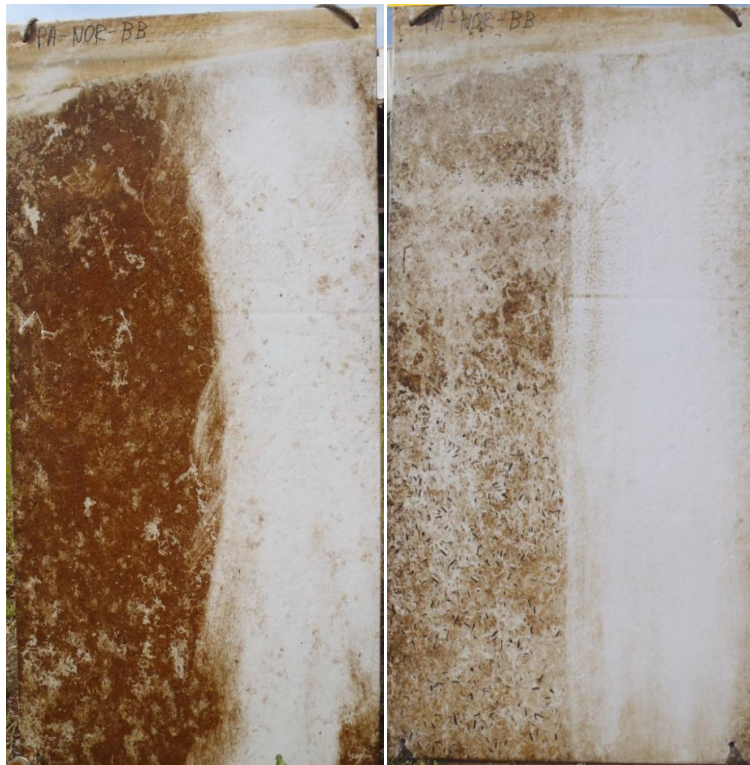
Abb. 25: Halbseitige Reinigung der Panadur-Platte mit der Beckmann Bürste (BB) am Norder Tief bei der ersten Reinigung am 21. Juni (links) und bei der zweiten Reinigung am 14. August.
