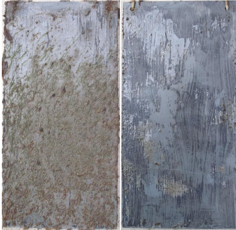
Abb. 53: PVC-Testplatte mit einer 4-lagigen Beschichtung der leicht polierenden Zinkantifouling Lotréc LeFant: Links vor und rechts nach der Behandlung mit dem Caviblaster. Es ist deutlich zu erkennen, dass dabei neben dem Bewuchs auch der Großteil der obersten Farbschicht abgelöst wurde.
