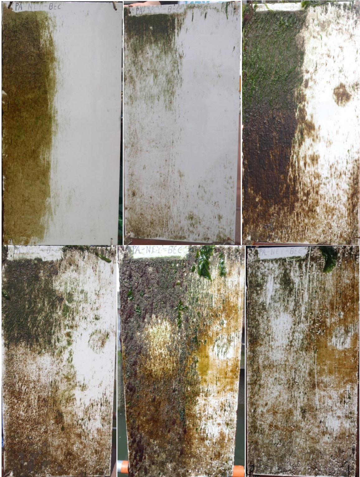
Abb. 33: Abwechselnd halbseitige und komplette Reinigung der Panadur-Platte mit dem Big Easy Cleaner im Norderneyer Hafen von der ersten Reinigung (links oben) bis zur letzten am 18. September (rechts unten).
