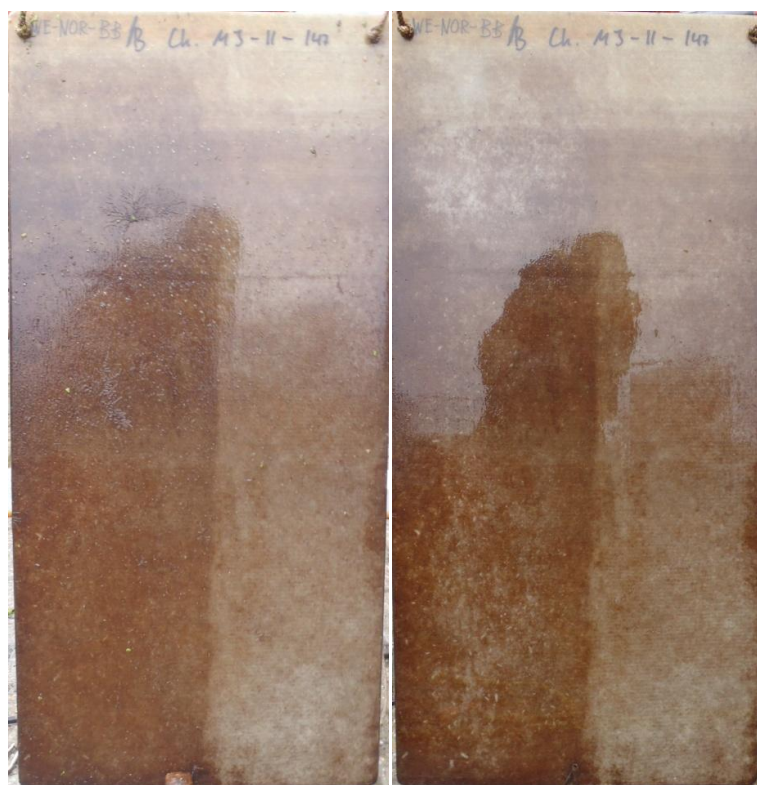
Abb. 28: Komplette Reinigung der WEST-Platte mit der Beckmann Bürste (BB) am Norder Tief bei der dritten Reinigung am 5. Oktober. Links vor, rechts nach der Reinigung.
