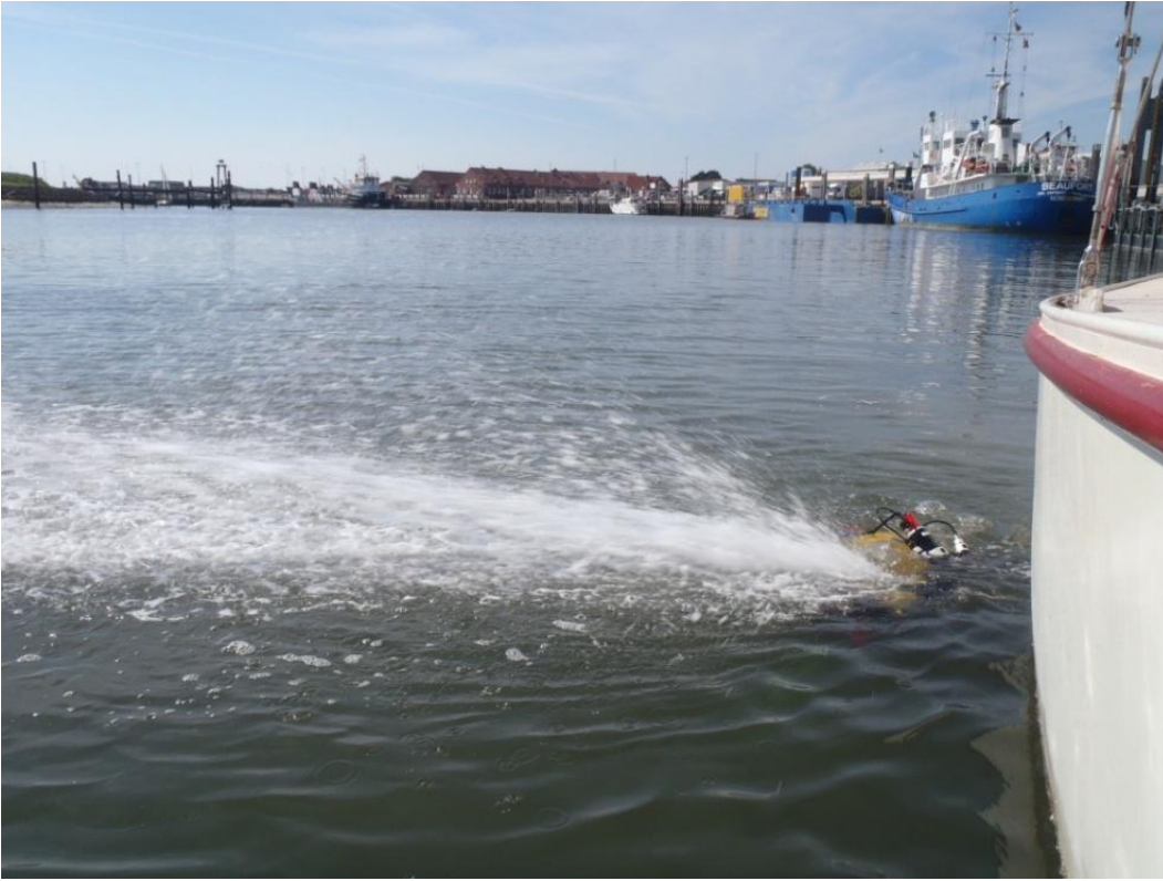
Abb. 77: Taucher mit Caviblaster im Einsatz bei der Windsbraut.
