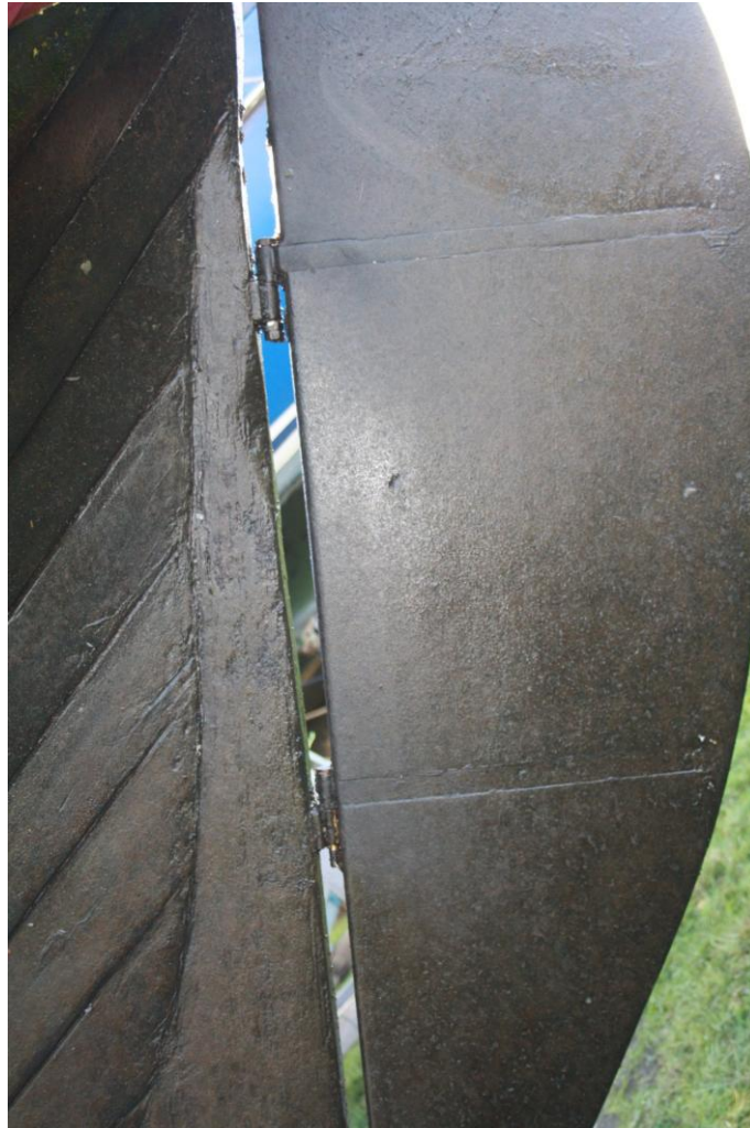
Abb. 30: Ruderblatt am Folkeboot Mette, beschichtet mit Cruiser Zero, Ratzeburger See am 10.10.2015 (Quelle: Segler-Verein Wakenitz e.V.).
