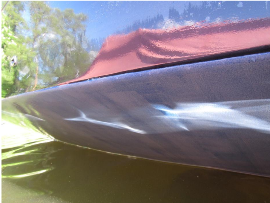
Abb. 56: Rumpf des Schwertzugvogels nach Reinigung mit dem Big Easy Cleaner am 07.05.2015 (Quelle: Bootseignerin).
