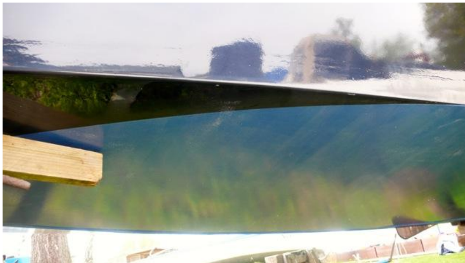
Abb. 54: Rumpf, Heckbereich Schwertzugvogel, nach Applikation von CleanTec im April 2015 (Quelle: Bootseignerin).
