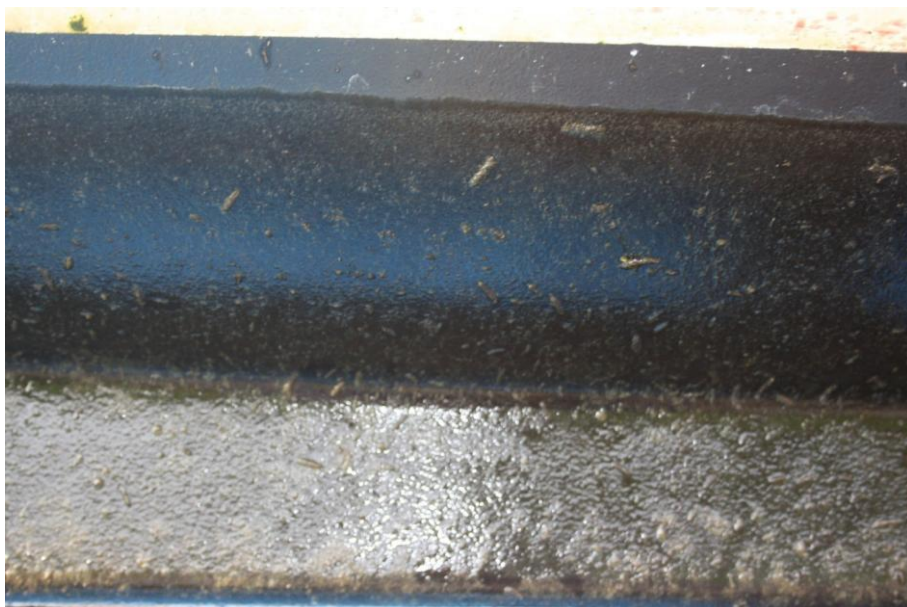
Abb. 15: Biofilm mit Insektenlarven am Rumpf der Magniola vor der Reinigung am 26.10.2015 (Quelle: LimnoMar).
