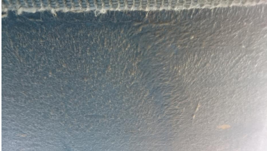
Abb. 9: Nahansicht Biofilm auf zwei Jahre alter Antifoulingbeschichtung am 08.06.2015 (Quelle: LimnoMar).
