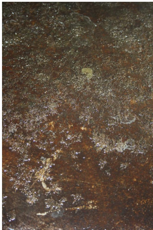
Abb. 62: Bewuchs am 24.10.2015 mit dichtem Biofilm und zahlreichen Schwämmen vor der Endreinigung (Quelle: LimnoMar).
