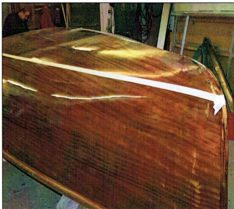
Der Rumpf nach dem mehrmaligen Lackieren mit Epoxid
