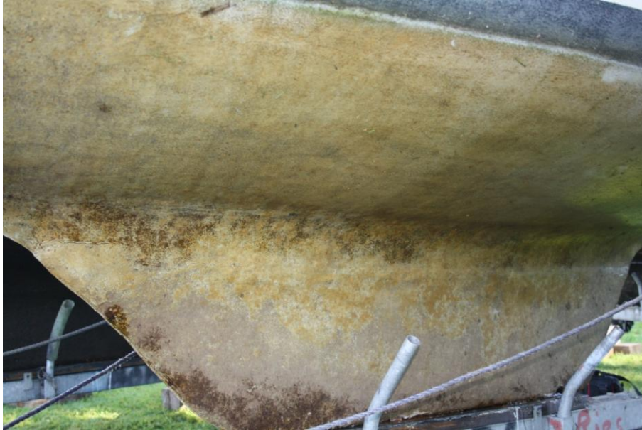
Abb. 21: Kielyacht Varianta 18, Rumpf mittschiffs mit Kiel und hellgrünem Biofilm bei der Abschlussinspektion am 10.10.2015 (Quelle: Segler-Verein Wakenitz e.V.).
