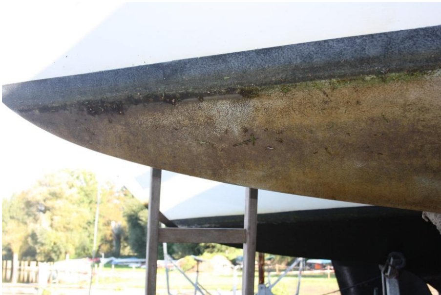
Abb. 22: Kielyacht Varianta 18, Rumpf Heckbereich mit bräunlichem Biofilm bei der Abschlussinspektion am 10.10.2015 (Quelle: Segler-Verein Wakenitz e.V.).
