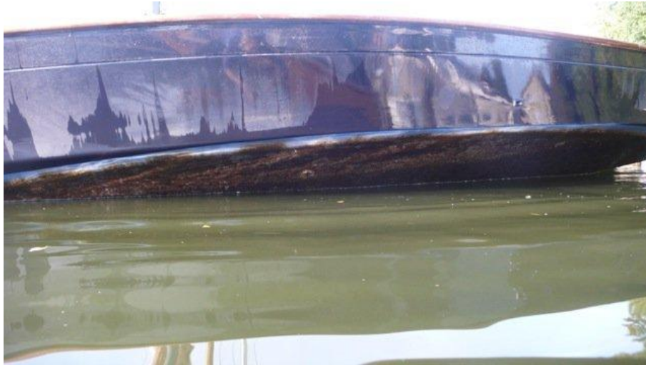
Abb. 61: Reinigung am 05.10.2015 mit dem Tausendbein, es verbleiben vorwiegend Schwämme auf dem Flachboden, in den helleren Streifen ist eine gewisse Reinigung erkennbar (Quelle: Bootseignerin).
