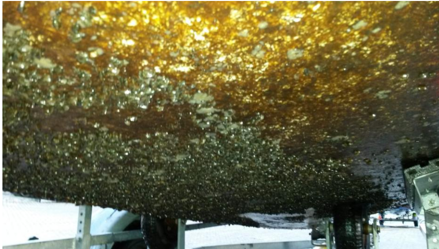
Abb. 40: Dichter Bewuchs mit Zebramuscheln, Schwämmen und kurzfädigen Grünalgen auf einem dichten Biofilm auf der Hanseatenstern am 01.10.2015 vor der Reinigung mit dem Hochdruckwascher (Quelle: Seglervereinigung der Hanseaten e.V.).
