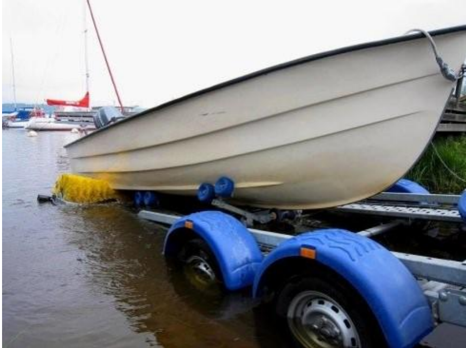
Abb. 72: Mobile Reinigungsanlage mit Bürsten auf einem Trailer (Quelle: LimnoMar).
