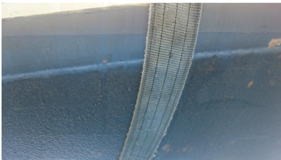
Abb. 8: Biofilm auf zwei Jahre alter Antifoulingbeschichtung am 08.06.2015 (Quelle: LimnoMar).
