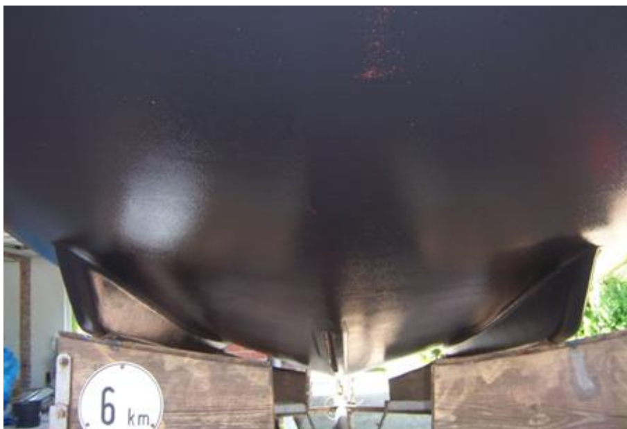
Abb. 11: Lanaverre Magniola mit reinigungsfähiger Epoxid-Beschichtung (Quelle: Seglerverein Hüste e.V.).
