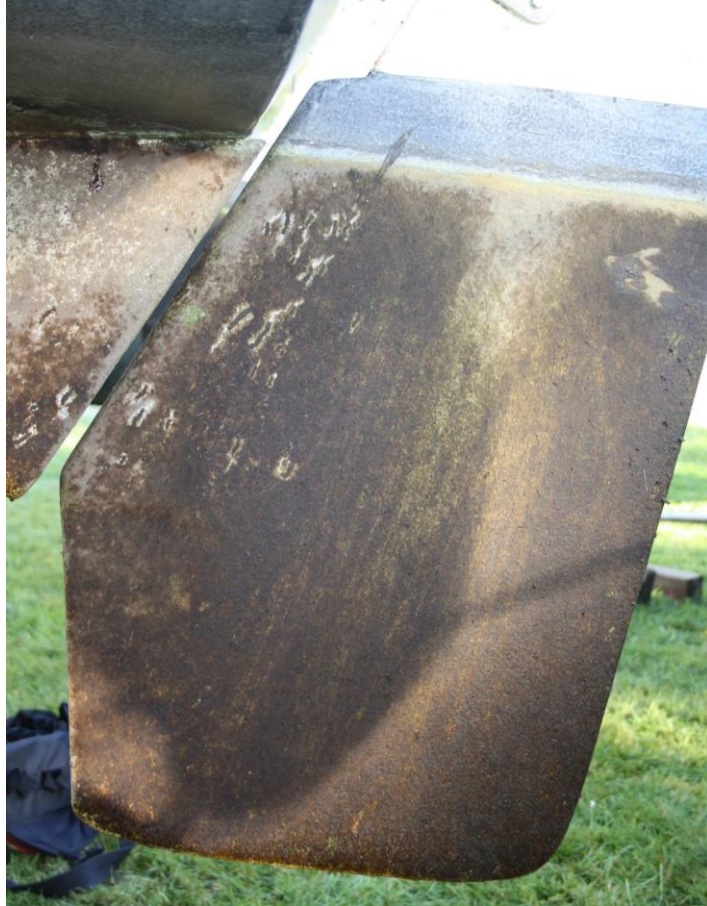
Abb. 23: Kielyacht Varianta 18, Ruder mit bräunlichem Biofilm und einigen Insektenlarven bei der Abschlussinspektion am 10.10.2015 (Quelle: Segler-Verein Wakenitz e.V.).
