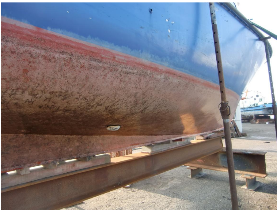
Abb. 65: Die W16 der Wasserschutzpolizei in der Werft in Oldersum 2014. Beschichtung mit CleanTec nach Reinigung (Quelle: LimnoMar).
