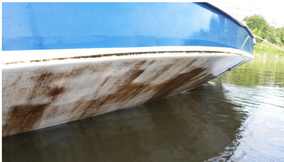
Abb. 39: Gereinigte und ungereinigte Flächen mit Biofilm auf dem Rumpf der Hanseatenstern nach der Reinigung am 23.07.2015 mit dem Big Easy Cleaner (Quelle: Seglervereinigung der Hanseaten e.V.).
