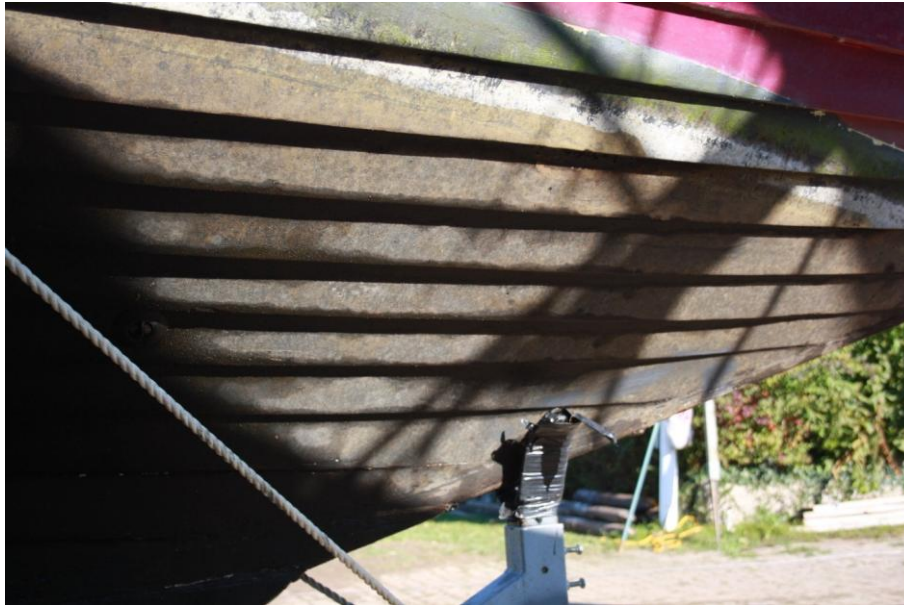
Abb. 28: Folkeboot Mette mit Biofilm, beschichtet mit Cruiser Zero, Ratzeburger See am 10.10.2015 (Quelle: Segler-Verein Wakenitz e.V.).
