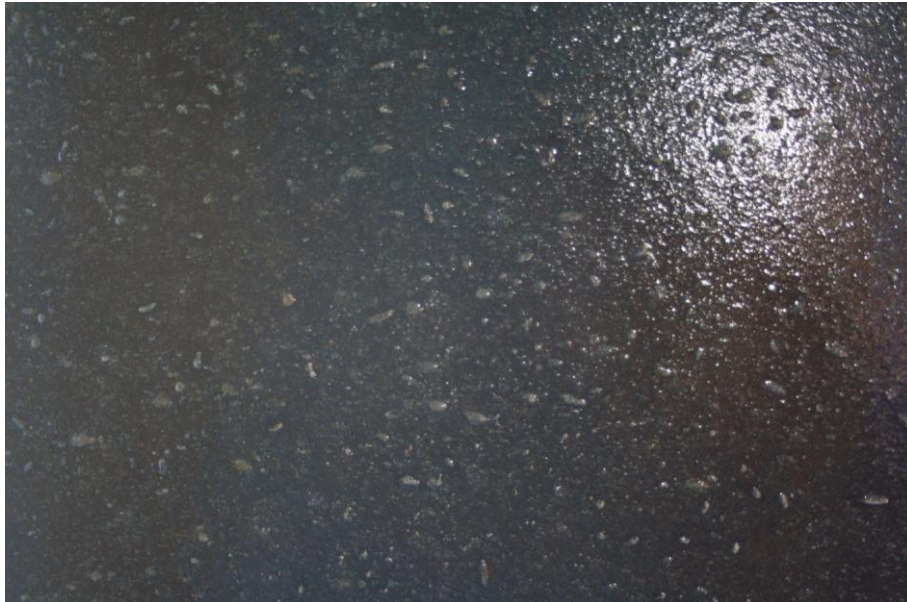
Abb. 14: Biofilm mit Insektenlarven am Rumpf der Magniola vor der Reinigung am 26.10.2015 (Quelle: LimnoMar).
