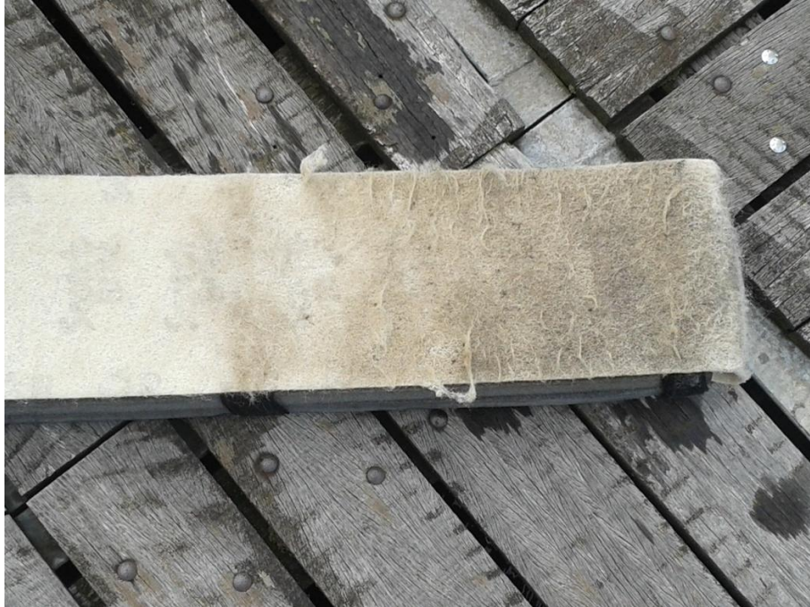
Abb. 49: Abnutzung des Pads des Big Easy Cleaners (Quelle: Seglervereinigung der Hanseaten e.V.).
