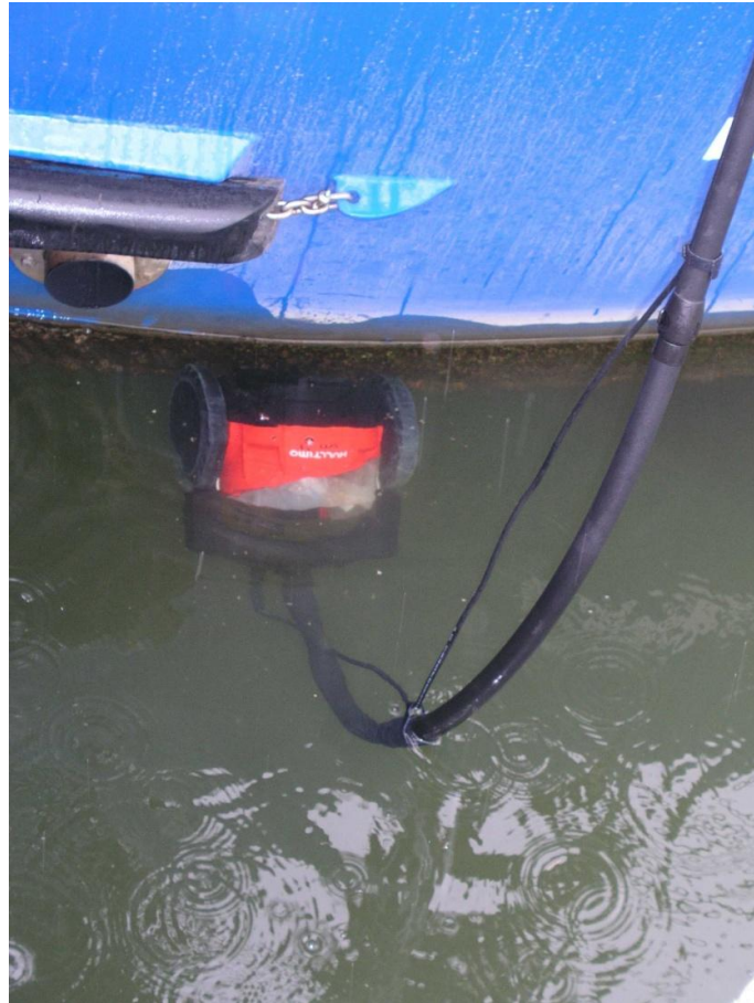
Abb. 68: Hulltimo smart in Aktion auf dem Rumpf der W16 (Quelle: LimnoMar).
