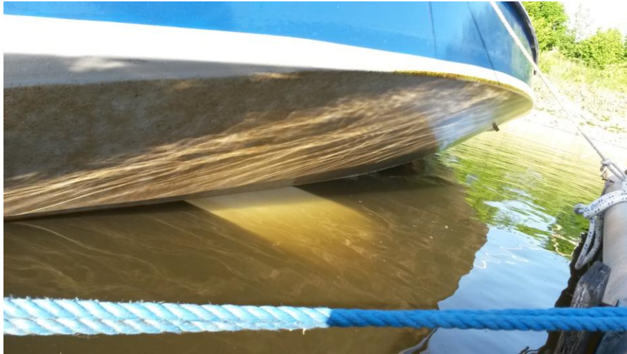
Abb. 34: Biofilm nach einstündiger Fahrt mit 5 kn auf der Hanseatenstern am 18.06.2015 vor der Reinigung mit dem Big Easy Cleaner (Quelle: Seglervereinigung der Hanseaten e.V.).
