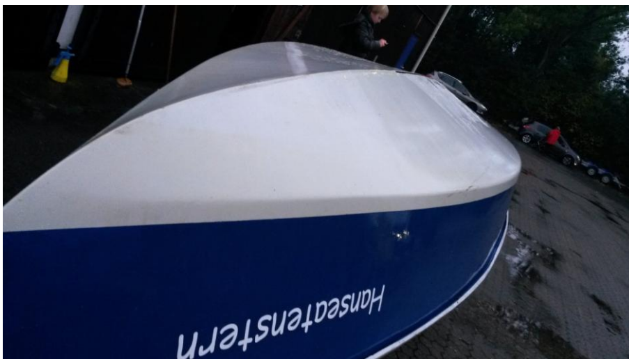
Abb. 43: Nach vollständiger Reinigung des Rumpfes der Hanseatenstern am 09.10.2015 mit Bürste und Schwamm unter Einsatz von Tensiden (Quelle: LimnoMar).
