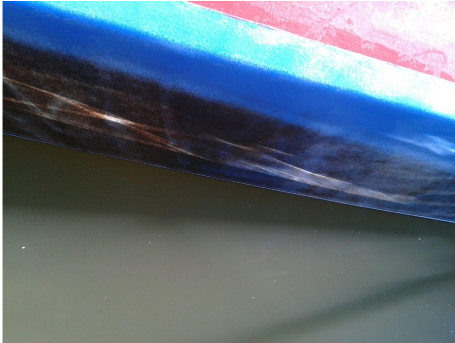
Abb. 46: Rumpf der Peregrina mit Biofilm am 04.06.2015 (Quelle: Seglervereinigung der Hanseaten e.V.).
