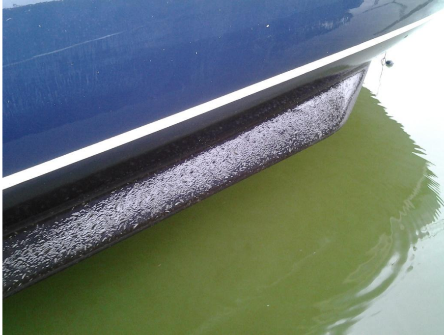
Abb. 12: Bewuchs auf der Magniola vor der Reinigung im Juli 2015 (Quelle: Seglerverein Hüde e.V.).
