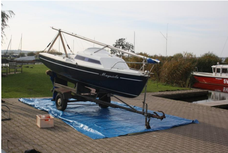
Abb. 16: Plane zum Auffangen des Bewuchses bei der Reinigung am 26.10.2015 in Hude (Quelle: LimnoMar).
