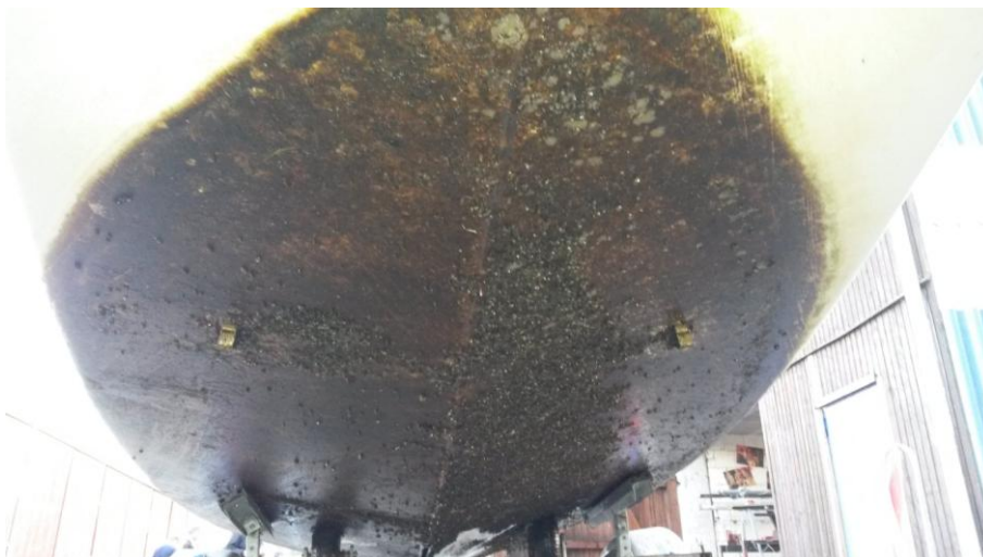
Abb. 41: Gesamtansicht der Rumpfes der Hanseatenstern am 01.10.2015 mit dichtem Bewuchs vor der Reinigung mit dem Hochdruckwascher (Quelle: Seglervereinigung der Hanseaten e.V.).
