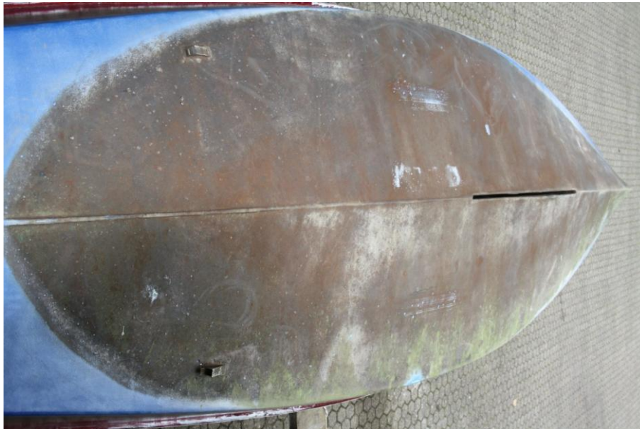
Abb. 51: Gesamtansicht des Rumpfes der Peregrina am 09.10.2015 nach der Reinigung mit dem Hochdruckwascher (Quelle: LimnoMar).
