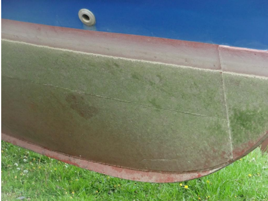
Abb. 66: Die W16 der Wasserschutzpolizei in der Werft 2015. Beschichtung CleanTec vor der Reinigung (Quelle: LimnoMar).
