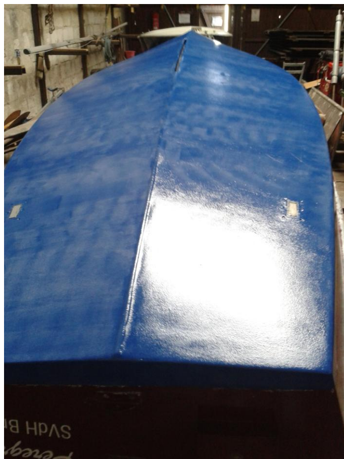
Abb. 44: Die Peregrina wurde im Mai 2015 bis auf den Primer entschichtet und mit der reinigungsfähigen Hartbeschichtung CleanTec beschichtet (Quelle: Seglervereinigung der Hanseaten e.V.).
