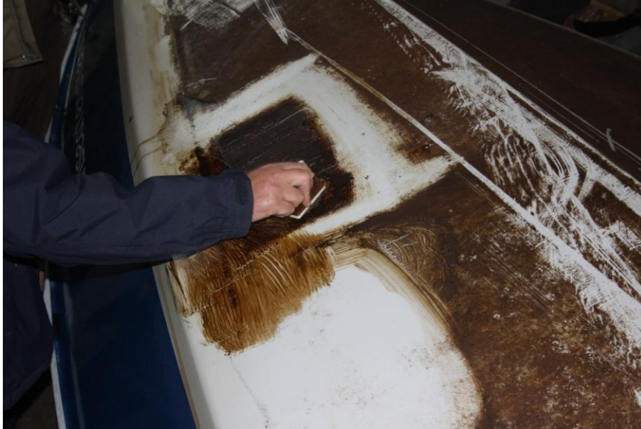
Abb. 42: Entfernung des verbliebenen Biofilms auf der Hanseatenstern am 09.10.2015 mit Bürste und Schwamm nach Anfeuchtung (Quelle: LimnoMar).
