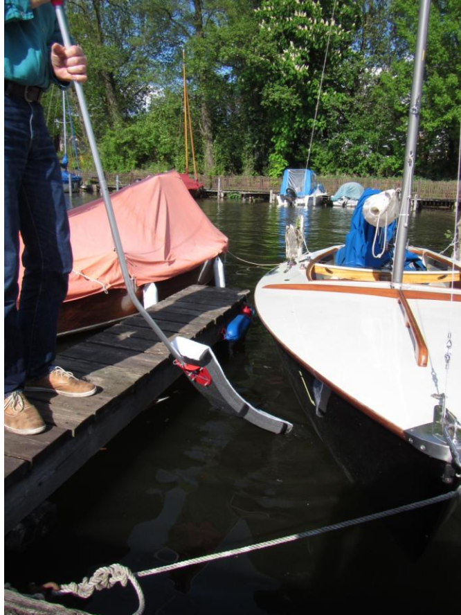
Abb. 58: Demonstration des Big Easy Cleaners am Rumpf des Schwertzugvogels am 07.05.2015 im Sportboothafen Bootshaus Rietz (Quelle: LimnoMar).
