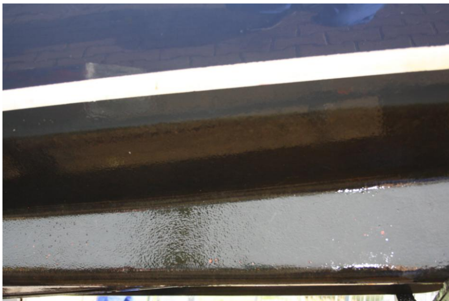
Abb. 18: Rumpf der Magniola nach Hochdruck-Reinigung am 26.10.2015 (Quelle: LimnoMar).
