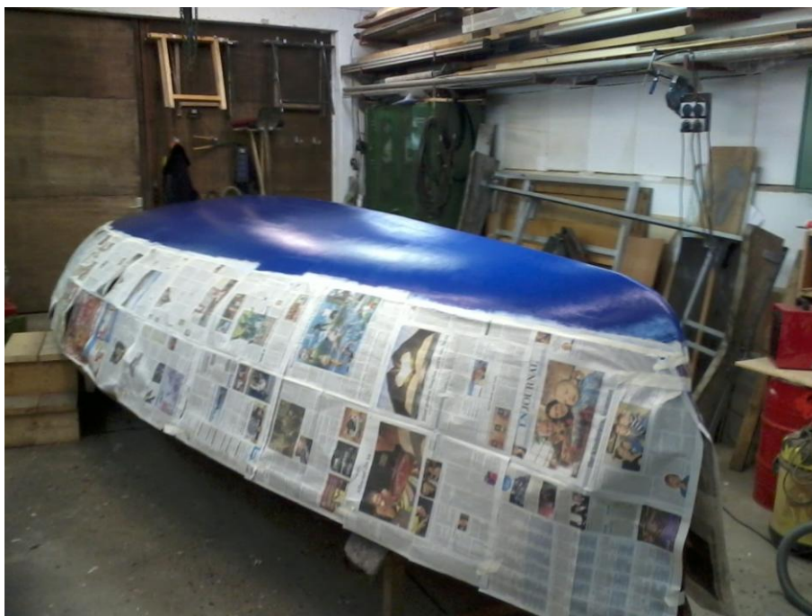
Abb. 25: Applikation der Beschichtung CleanTec auf den Jollenkreuzer El Gordito (Quelle: Segler-Verein Wakenitz e.V.).
