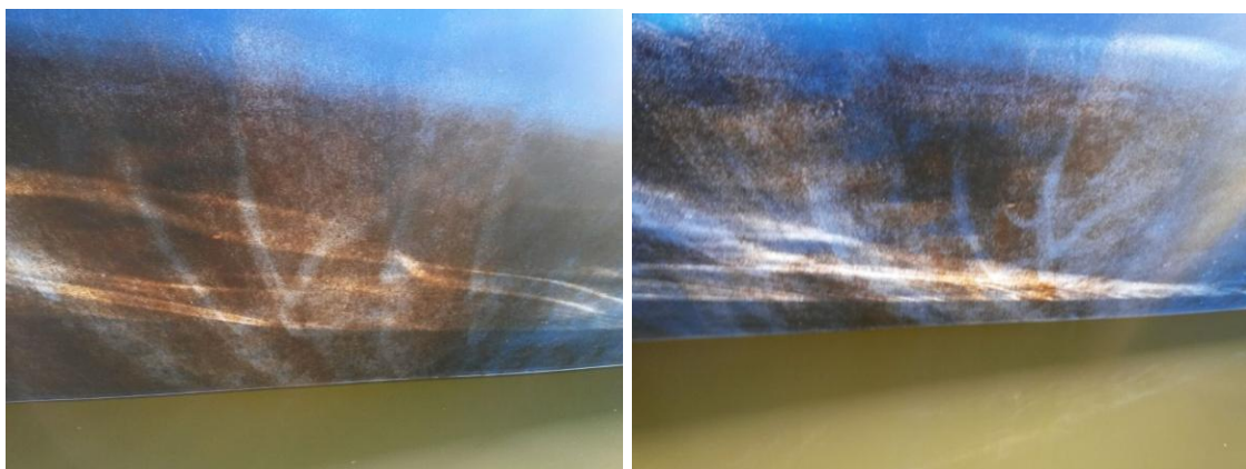
Abb. 47: Rumpfausschnitt der Peregrina vor (links) und nach (rechts) der Reinigung am 02.07.15 mit dichtem Biofilm (Quelle: Seglervereinigung der Hanseaten e.V.).
