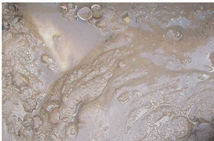
Abbildung 2.3-3 Übersichtsfoto der Sedimentprobe der Stelle S3 (m 61,4 – 61,2, links), Wassertiefe: 1,0 m, Beschaffenheit nach optischer Ansprache: 90 % Schlamm, 8 % Corbicula , 2 % Pflanzen
