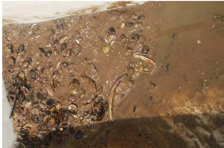
Abbildung 2.3-1 Übersichtsfoto der Sedimentprobe der Stelle S1 (km 63,0 – 62,9, rechts), Wassertiefe: 3,6 m, Beschaffenheit nach optischer Ansprache: 5 % Schlamm, 40 % Schill, 55 % Sand
