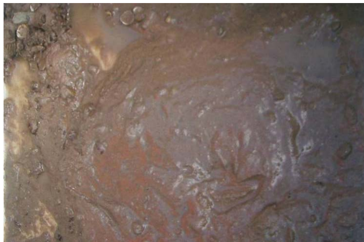
Abbildung 2.3-2 Übersichtsfoto der Sedimentprobe der Stelle S2 (km 61,85 – 61,65, rechts), Wassertiefe: 4,3 m, Beschaffenheit nach optischer Ansprache: 5 % Schlamm, 5 % Corbicula , 90 % Sand
