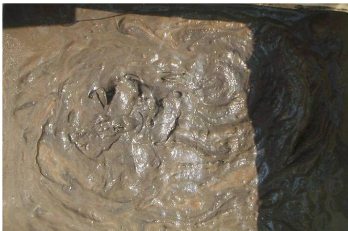
Abbildung 2.3-4 Übersichtsfoto der Sedimentprobe der Stelle S4 (km 61,0 – 60,6, links), Wassertiefe: 1,7 m, Beschaffenheit nach optischer Ansprache: 90 % Schlamm, 8 % Corbicula, 2 % Pflanzen
