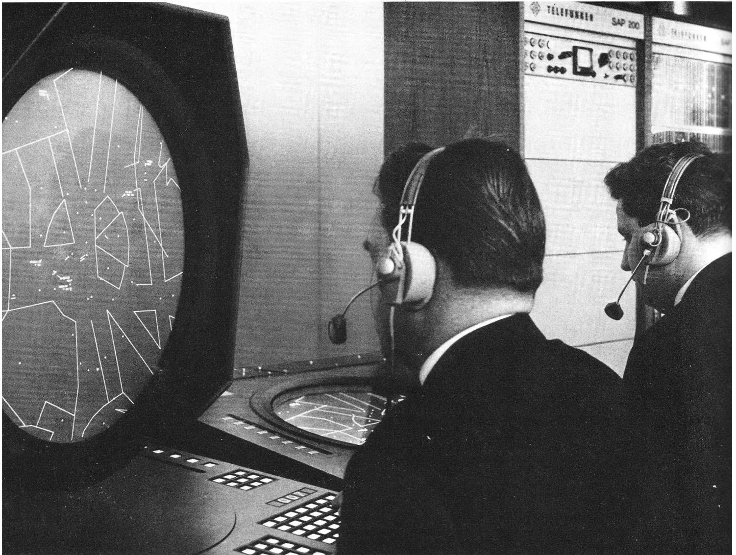
Bild 2. Für die Luftlagedarstellung bei der Bundesanstalt für Flugsicherung in Frankfurt am Main installierter Schirmbild-Arbeitsplatz Telefunken SAP 200. Zwei elektronische Sichtgeräte mit 50-cm-Bildröhren sind über eine gemeinsame Steuerelektronik mit Bildwiederholungsspeicher und Zeichengenerator an einen Telefunken-Rechner TR 4 angeschlossen
