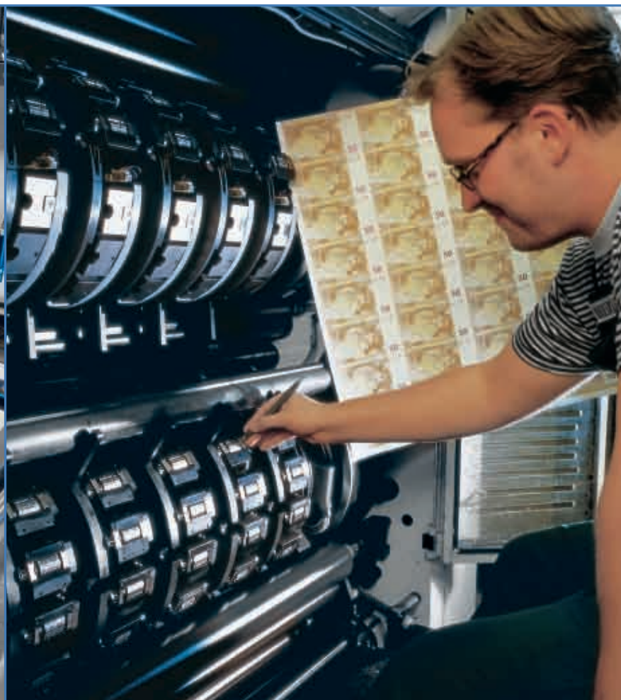
O presă de numerotat. Fiecare bancnotă are un număr și o serie unice.
