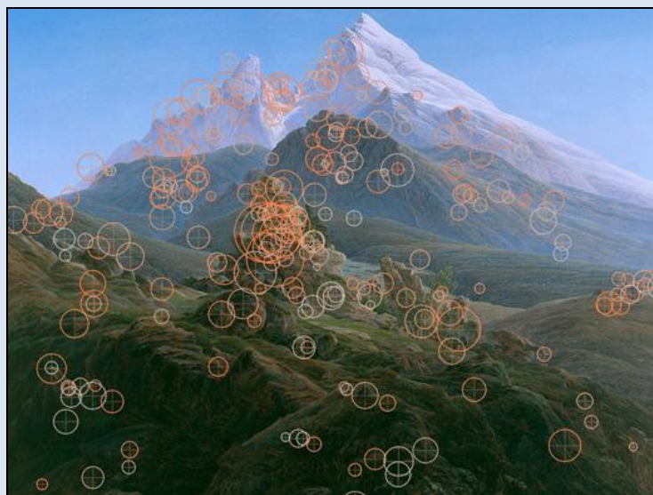
Aufzeichnung der Fixierpunkte mit einem Eyetracker
