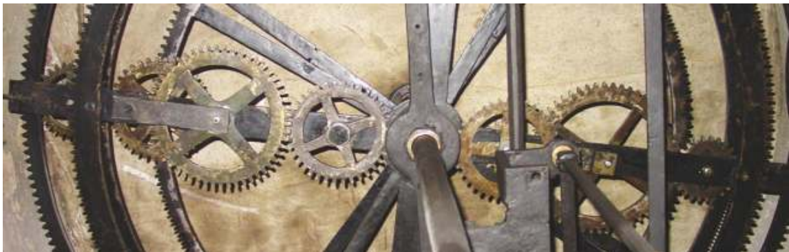
FIG. 3.32 – L'astrolabe, vu de l'intérieur. Train de l'araignée à gauche, train de la Lune à droite.
