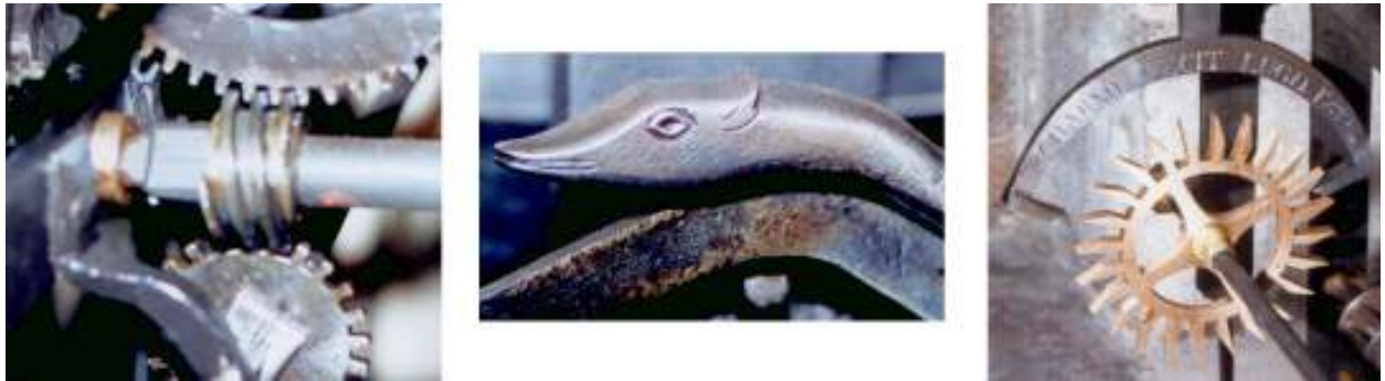
FIG. 3.37 – Vis sans fin, salamandre du changement d'année, ancre de 1782 et roue d'échappement.
