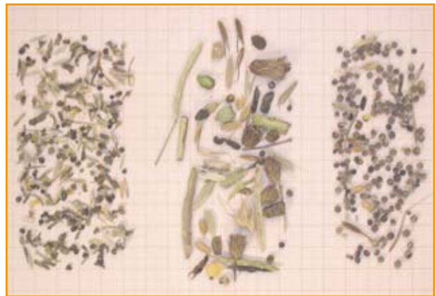
Abb. 34: Verschiedene Besatzfraktionen nach Reinigung (von links nach rechts: Steigsichter, Obersieb und Untersieb)
