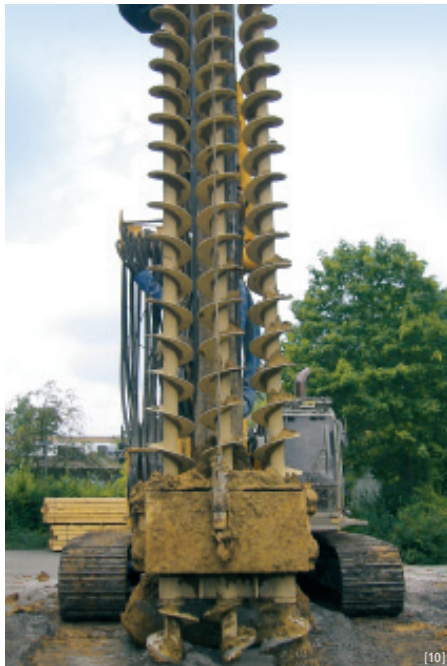
Oben: Das MIP-Gerät. Gut erkennbar ist die Dreifachschnecke.
