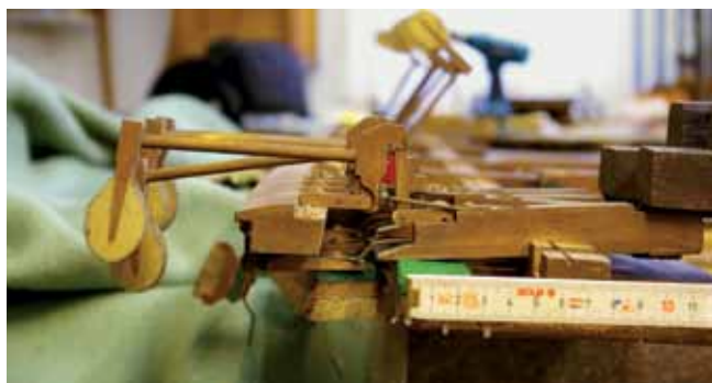
Mechanik des Pédaliers aus dem Schumann-Haus zu Zwickau, aufgenommen in der Restaurierungswerkstatt.
