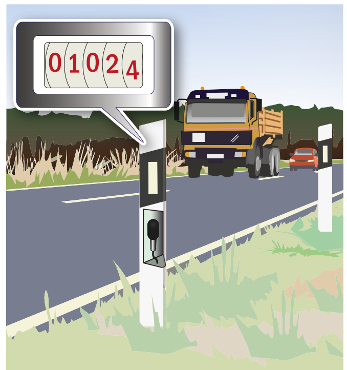
In einem Modellversuch werden herkömmliche Leitpfosten mit einem Mikrofon ausgerüstet. Das System soll ein exaktes Bild der Lärmbelastung an einzelnen Strecken ermöglichen.
