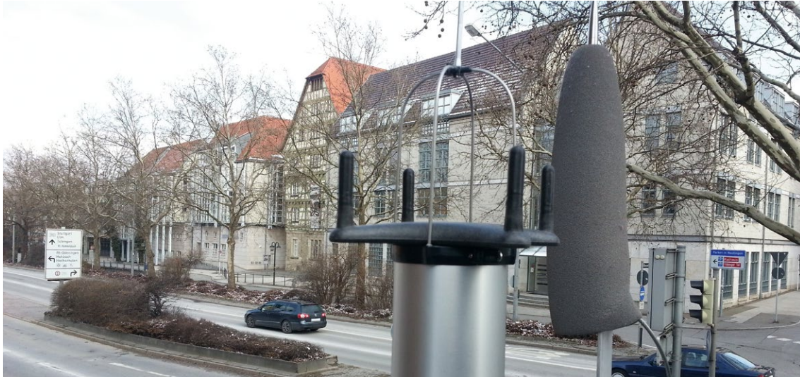
Zur Dokumentation der langfristigen Entwicklung von Verkehrsgeräuschen an Straßen betreibt die LUBW an ausgewählten Standorten Dauermessstationen.
