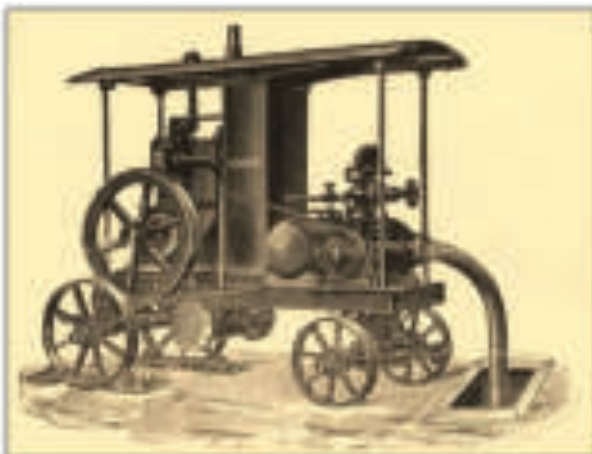
Sonderanwendungen des Modell A: Pumpenlokomobile und Steinbrecher-Anlage mit gekapseltem Motor als Selbstfahrer
