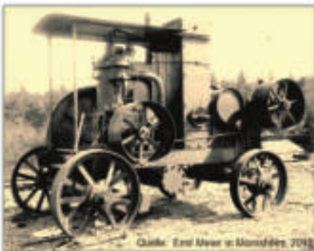
Lokobile GNOM Modell A, Antrieb einer Kabelwinde für die Feldbahn eines Steinbruchs bei Pappenheim
