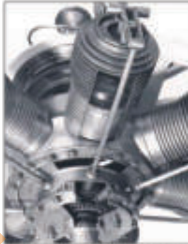
Ventilsteuerung des 7-Zylinder Gnome Quelle: Andrew Norton, The Henry-Engels, London 1987
