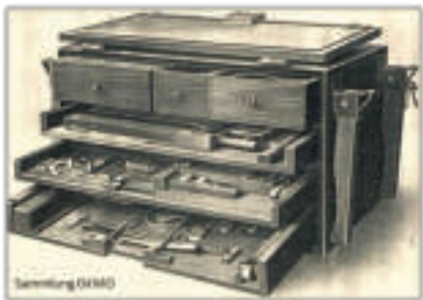
Transportable Motor-Einheitkiste B mit Werkzeugen für die Motorenwartung bei den Jagdstaffeln im Feld
