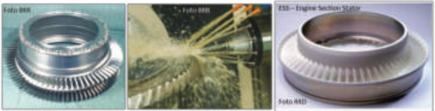
BR715 Niederdruckverdichter in BLISK-Bauweise sowie der BR715 NDV-Leitkranz ESS als „blade integrated ring“ (BLING)
