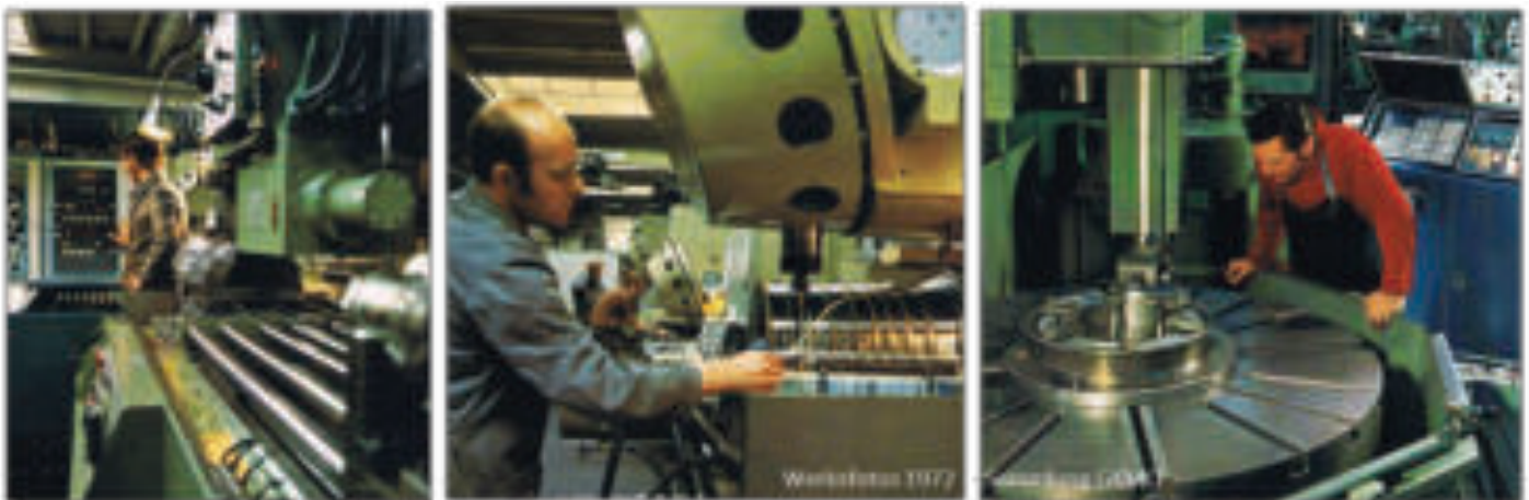
Fräs- und Bohrbearbeitung des T64-Verdichtergehäuse auf NC-Starrag und NC-Olivetti und Zwischengehäuse auf NC-Froriep
