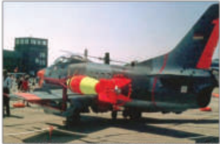
Eine der bei Condor Flugdienst zur Flugzieldarstellung für die Bundeswehreingesetzten G-91 mit Bojen-Schleppeneinrichtung
