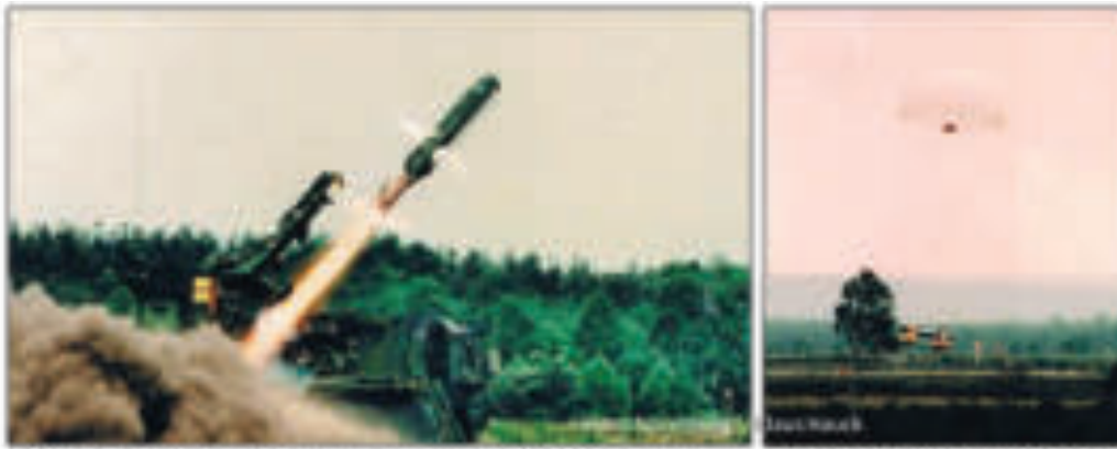
Drohnenstart vom Launcher mittels Feststoff-Booster und Landung mit Fallschirm und Luftkissen
