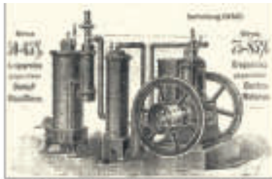
Gnom-Motor mit Generatorgasanlage, um 1900 Links außen der Generator, dann die Vorlage, der Koks-Reiniger und der etwas verdeckte Gas-Sammeltopf
