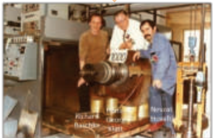
19. Mai 1981 – Die 1000ste Hochdruck-Verdichtertrommel nach dem elektronenstrahlschweißen ihrer fünf Einzelbauteile
