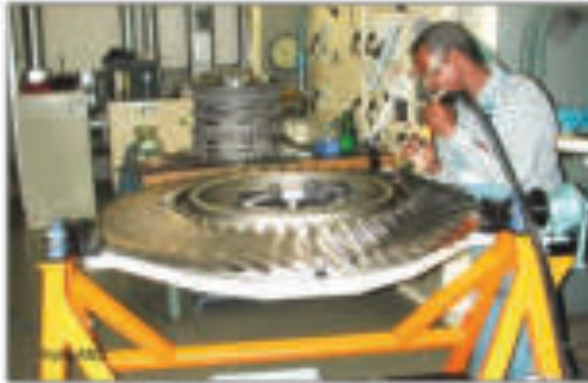
Dezember 2002 – BLISK des Lift-Fan für den Joint Strike Fighter
