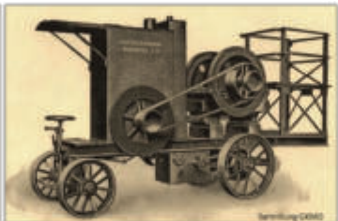
Sonderanwendungen des Modell A: Pumpenlokomobile und Steinbrecher-Anlage mit gekapseltem Motor als Selbstfahrer
