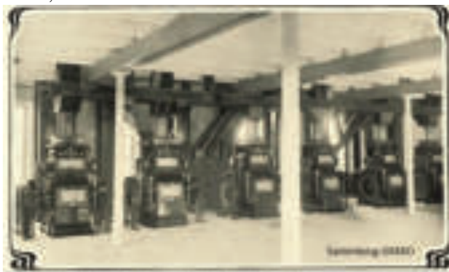
Walzenstühlboden in einer netzgroßen Gebrüdermühle um 1906 Im Werkmuseum Motorenfabrik steht ein Walzenstuhl dieses Typs
