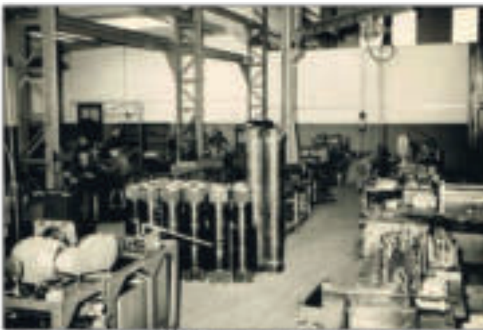
Gemischtfertigung 1958 in Werkhalle 02, links die Montage von Rohrbündelkühlern, rechts das Löten von Rohrleitungen.
