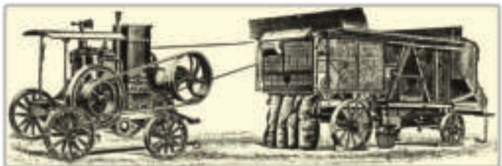
1898 herausgebrachte Petroleum-Lokomobile GNCM Modell A mit Dreschwagen
