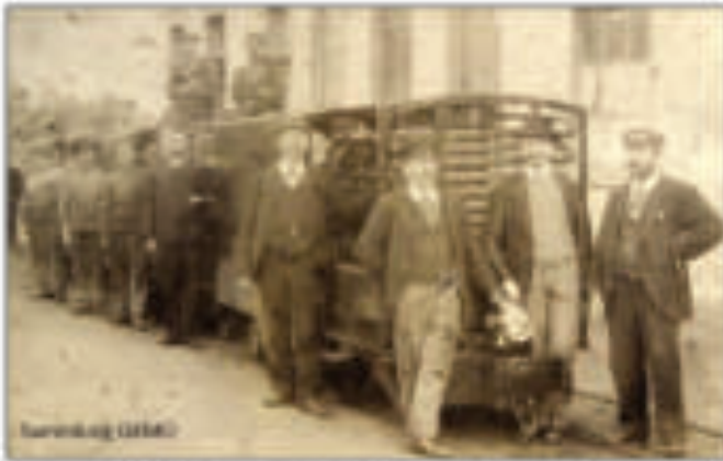
Die erste, 1900 für den Eigenbedarf gebaute Rangierlokomotive mit 8 PS-Spiritomotor GNOM; Ganz rechts Meister Mengel, dann Friedrich Seck, ein weiterer Werkmeister und Meister Hornm
