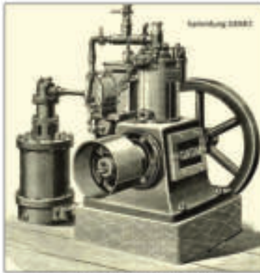
3 PS-Benzinmotor GNOM von 1898 Links der Apparat zur Vergasung des Benzins, am Motor ein Sicherheitskopfl mit Klappe zur Verhinderung von Flammenrückschlag. Elektromagnetischer Zünd-Apparat mit Nulfselenmagnet und Induktionspule
