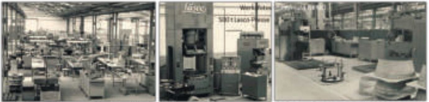
Die spanlose Fertigung, mit Bereichen für die Umformung und Stanzerlei sowie die Elektro-, Punkt- und Rollnahtschweißerei
