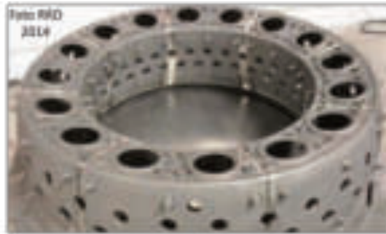
Prototyp-Brennkammer Advance 2, hergestellt aus acht miteinander verschwei ten DLD-Segmenten
