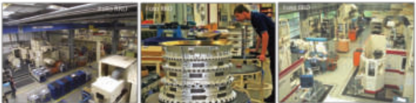
Fertigungsinsel „Housings“ in der Blauen Halle 38 um 2005 – Mitte: Geteiltes Verdichtergehäuse
