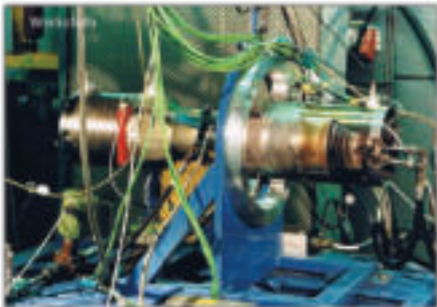
Das Schubtriebwerk WJ119-3 auf dem Erprobungs-Prüfstand im Turmbau und nach erfolgreichem Abschluss der Erprobungen
