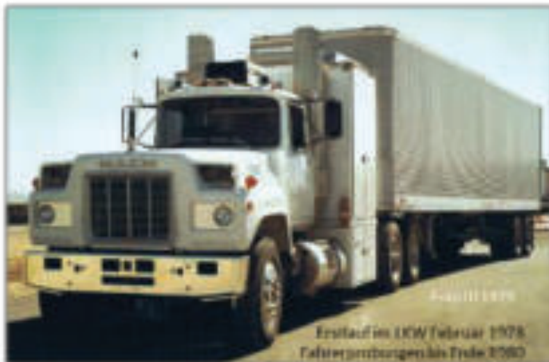
Der erste GT601-Erprobungsträger – Der Turbinen-LKW Mack R-995 1981 erhielt dieses Fahrzeug das Fahrerhaus eines Mack Super Liners
