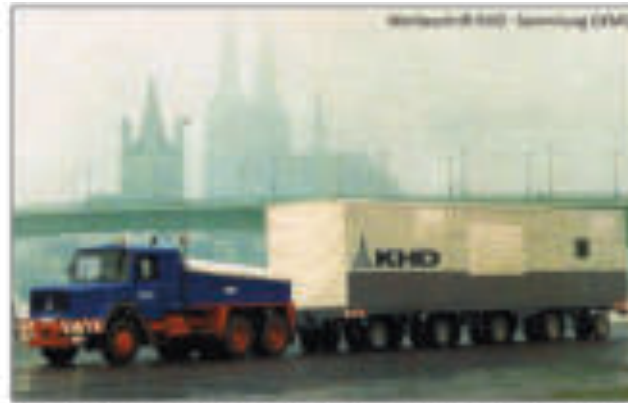
Auslieferung eines der mobilen 4,2 MW Kraftwerke TF35. Rechts: Die beiden TF35-Gasturbinen mit Yacht-Sammelgetriebe
