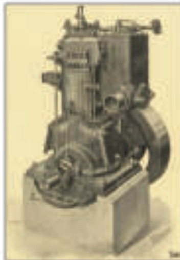
Die erste Generation der ab 1922 in Oberursel gefertigten Zweitakt-Diesel-Glühkopfmotoren
