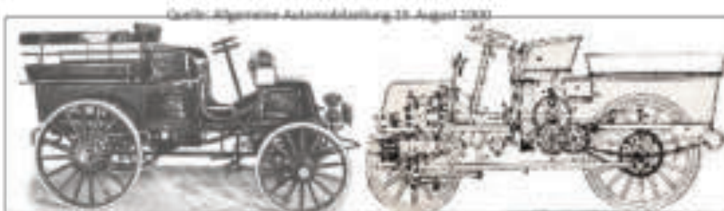
Scheibler Break mit 6 PS Motor, Ansicht und Prinzip-Skizze mit Motor, Reibradgetriebe und Achsantrieb
