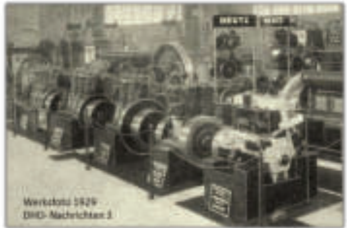
Leipziger Frühjahrsmesse 1929 – Vorn der Oberurseler Fahrzeugmotor FMV 117, daneben vier 9M-Motoren mit 1bis 4 Zylindern
