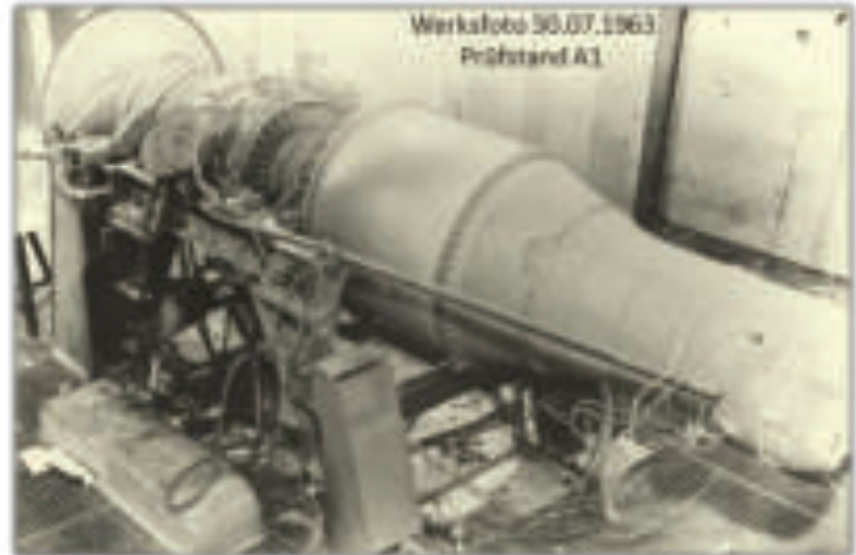
Das nach dem Bersten einer Verdichterscheibe explodierte Triebwerk
