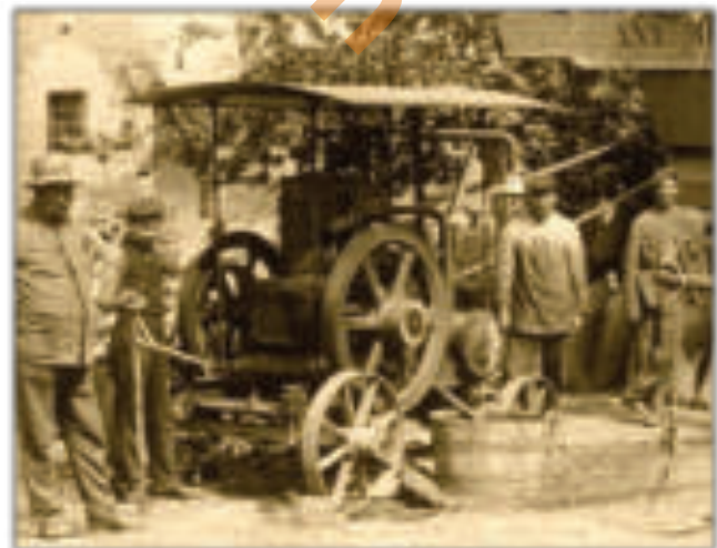
Lokobile GNOM Modell C mit Durchlaufkühlung, hier ein Lizenzbau Dobry als Antrieb einer Dreschmaschine
